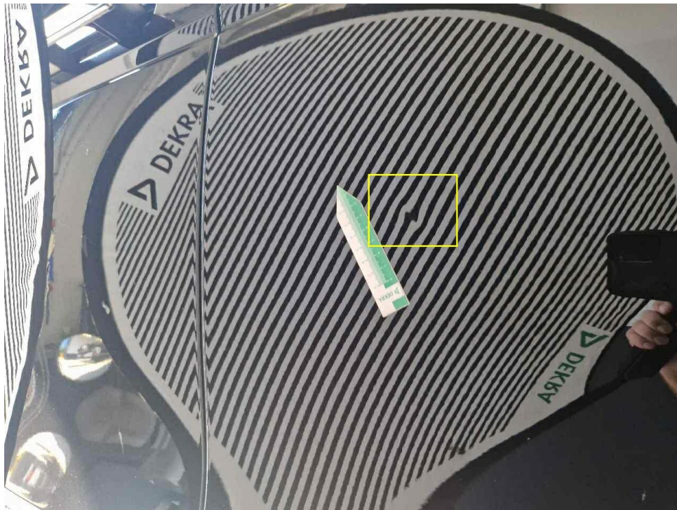
Bild 29 : Tür hinten links eingedellt
