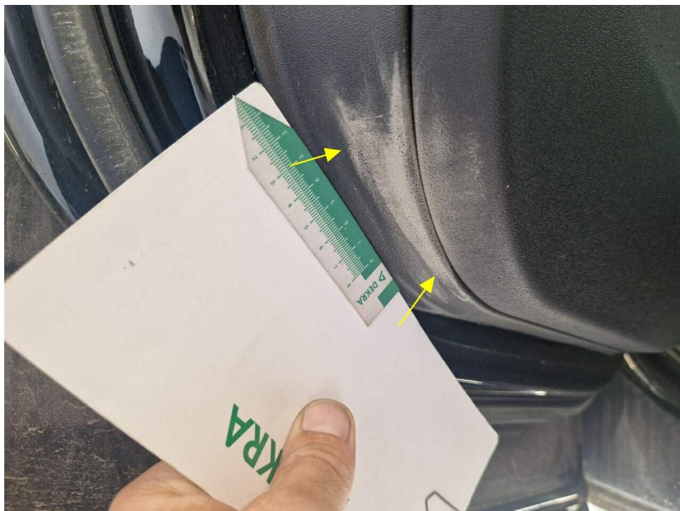
Bild 24 : Türverkleidung hinten links verschrammt
