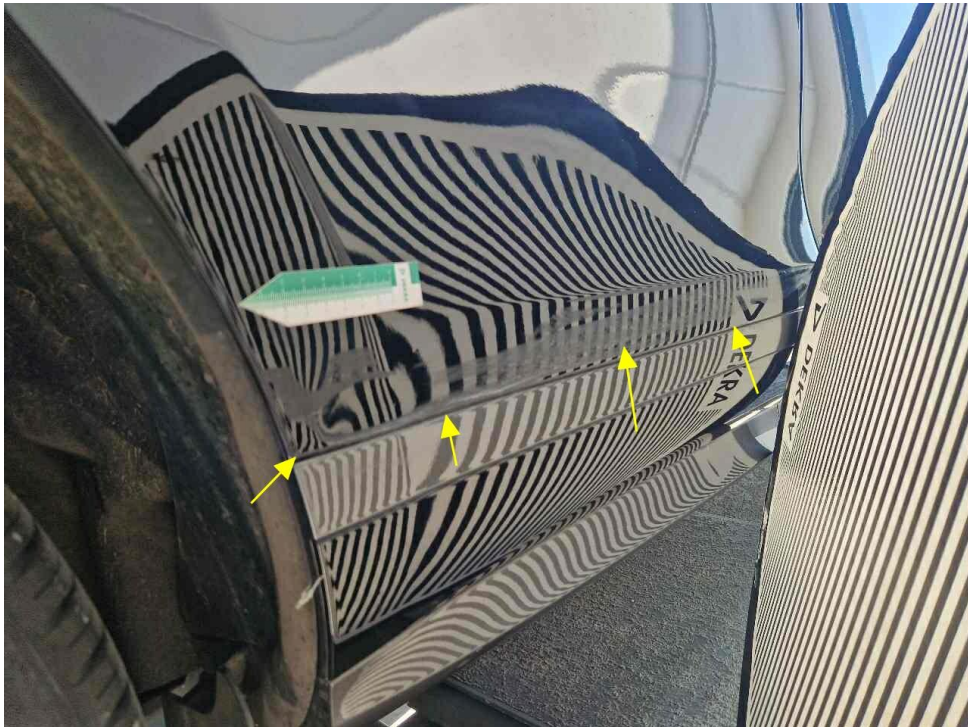
Bild 25 : Tür hinten rechts ei gedrückt und zerkratzt
