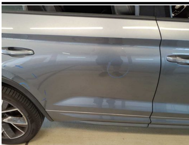
Beschädigung #16: Tür hinten rechts: Tür - Delle / Lackschaden - instandsetzen und lackieren
