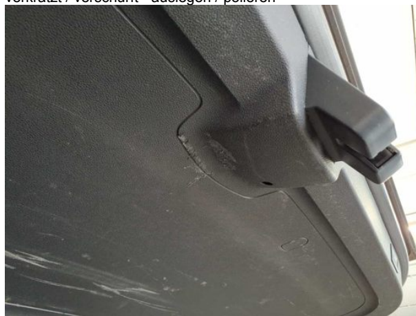
Beschädigung #3: Verkleidungen/Abdeckungen: Kofferraumverkleidung - verkratzt / verschürft - Wertminderung
