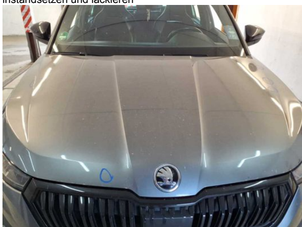
Beschädigung #17: Motorhaube: Motorhaube - Delle / Lackschaden - instandsetzen und lackieren
