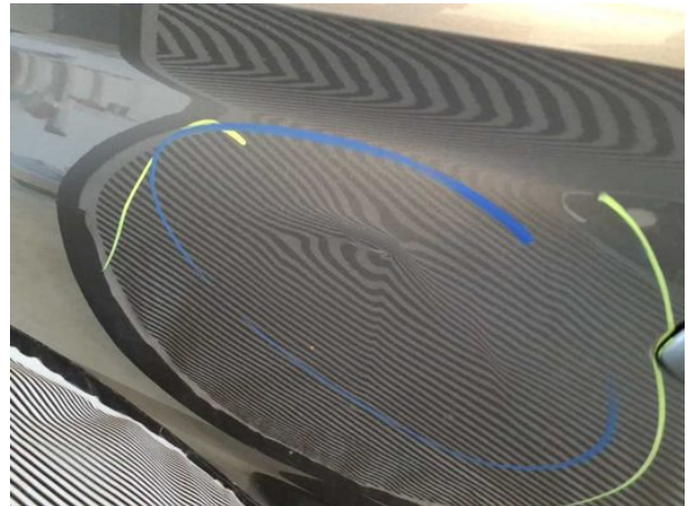
Beschädigung #18: Tür vorn links: Tür - Delle / Lackschaden - erneuern
