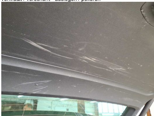
Beschädigung #3: Verkleidungen/Abdeckungen: Kofferraumverkleidung - verkratzt / verschürft - Wertminderung
