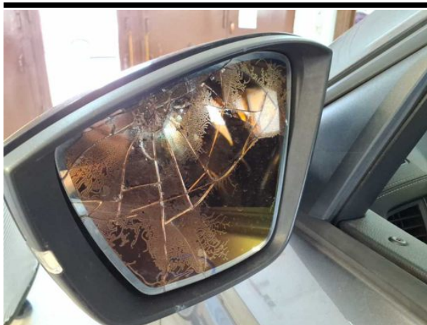
Beschädigung #8: Außenspiegel links: Spiegelglas - beschädigt - erneuern
