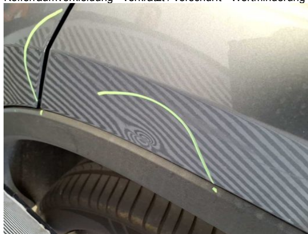
Beschädigung #4: Seitenwand links: Seitenwand - Delle(n) - sanft instandsetzen
