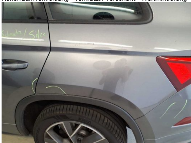
Beschädigung #4: Seitenwand links: Seitenwand - Delle(n) - sanft instandsetzen
