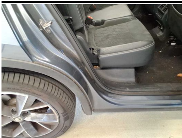
Beschädigung #5: Seitenwand rechts: Einstieg - Delle / Lackschaden - Smart Repair
