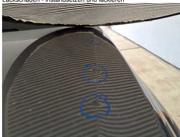
Beschädigung #17: Motorhaube: Motorhaube - Delle / Lackschaden - instandsetzen und lackieren
