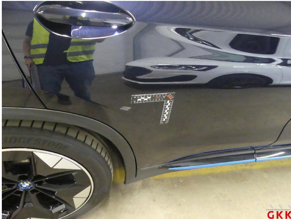
Bild 21 Tür hinten rechts, verkratzt, lackieren
