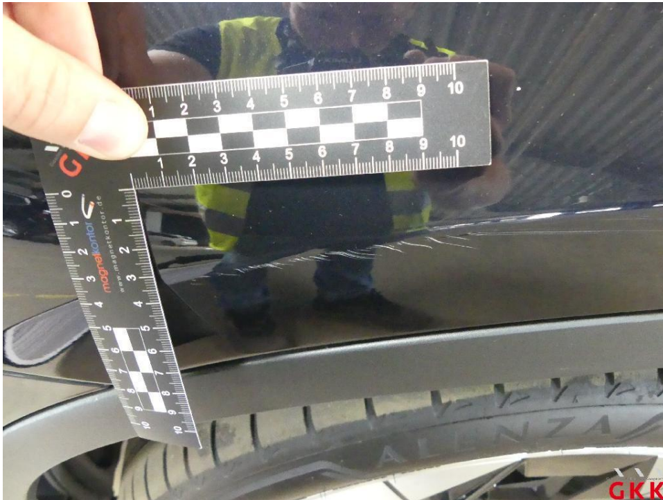
Bild 15 Kotflügel vorne links, verkratzt, lackieren
