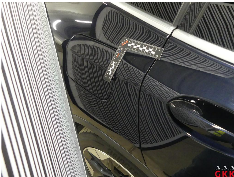
Bild 26 Seitenwand rechts, beschädigt, instand setzen - lackieren
