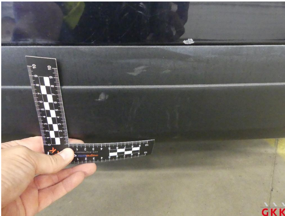
Bild 34 Stoßfänger hinten, Verkleidung unterhalb -unlackiert-, verkratzt, ersetzen
