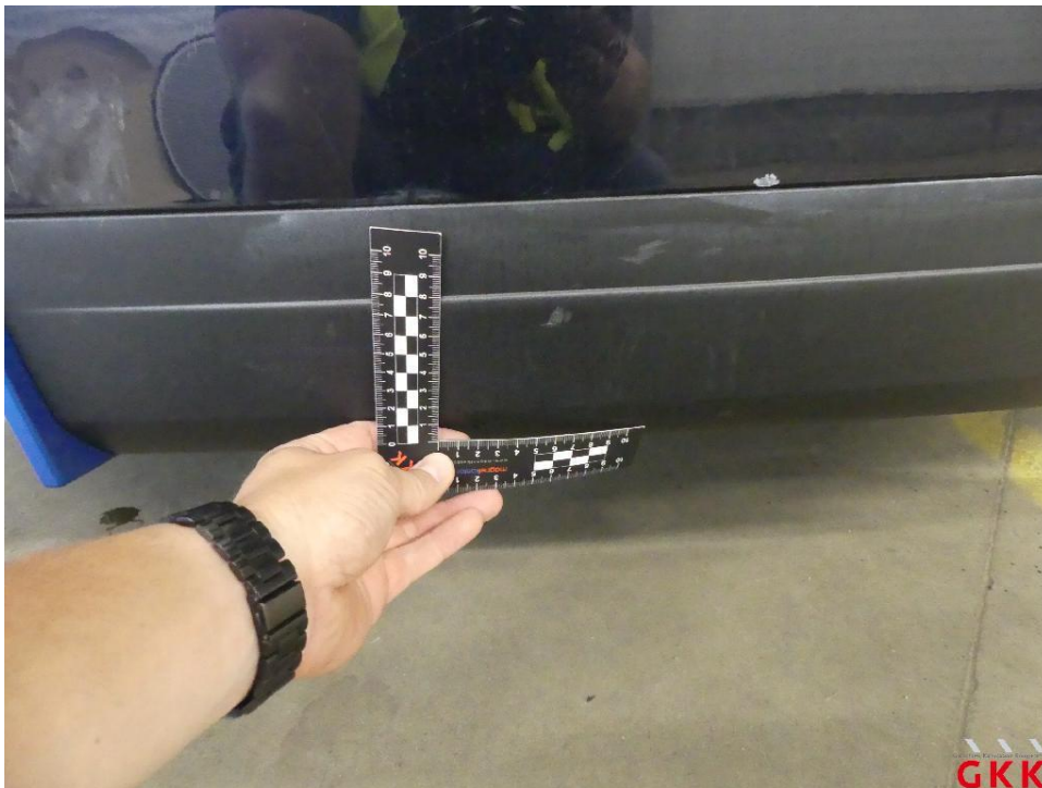
Bild 32 Stoßfänger hinten, Verkleidung unterhalb -unlackiert-, verkratzt, ersetzen
