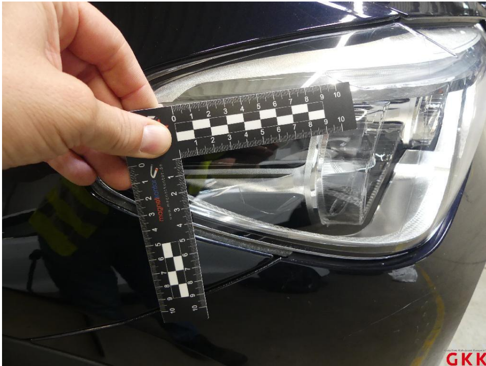
Bild 17 Scheinwerfer rechts LED, verkratzt, ersetzen
