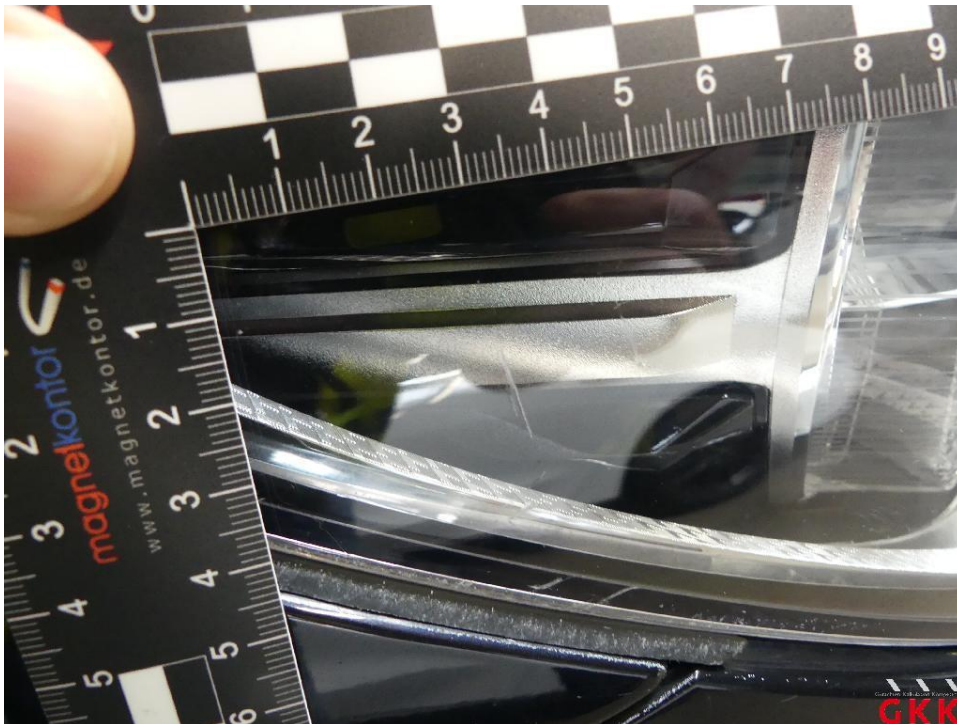
Bild 18 Scheinwerfer rechts LED, verkratzt, ersetzen
