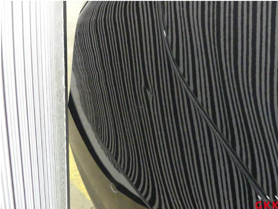
Bild 31 Stoßfänger hinten, Verkleidung -lackiert-, beschädigt, ersetzen
