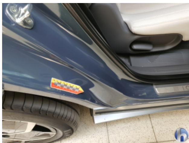
1. Türeinstieg Hinten - Rechts Kratzer - Smart Repair
