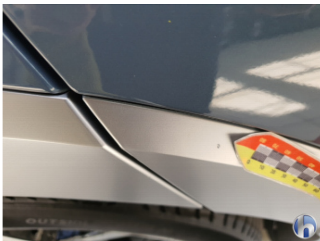
7. Tür Hinten - Rechts Gebrauchsspuren - Ohne Reparatur
