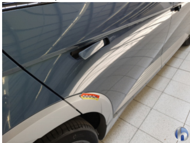
7. Tür Hinten - Rechts Gebrauchsspuren - Ohne Reparatur
