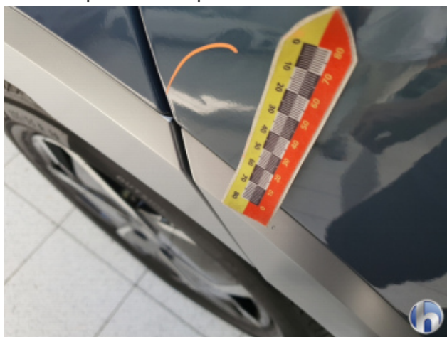
7. Tür Hinten - Rechts Gebrauchsspuren - Ohne Reparatur
