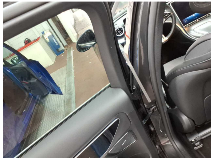
Damage 1: Door - rear left side: Door (Türdichtung) - Broken / torn - Replace
