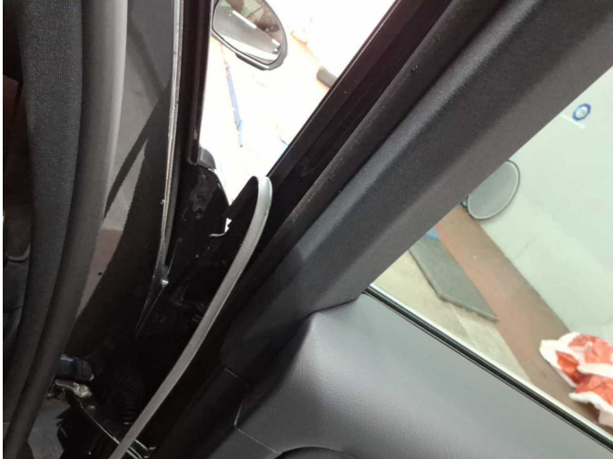
Damage 2: Door - rear right side: Door (Türdichtung) - Broken / torn - Replace
