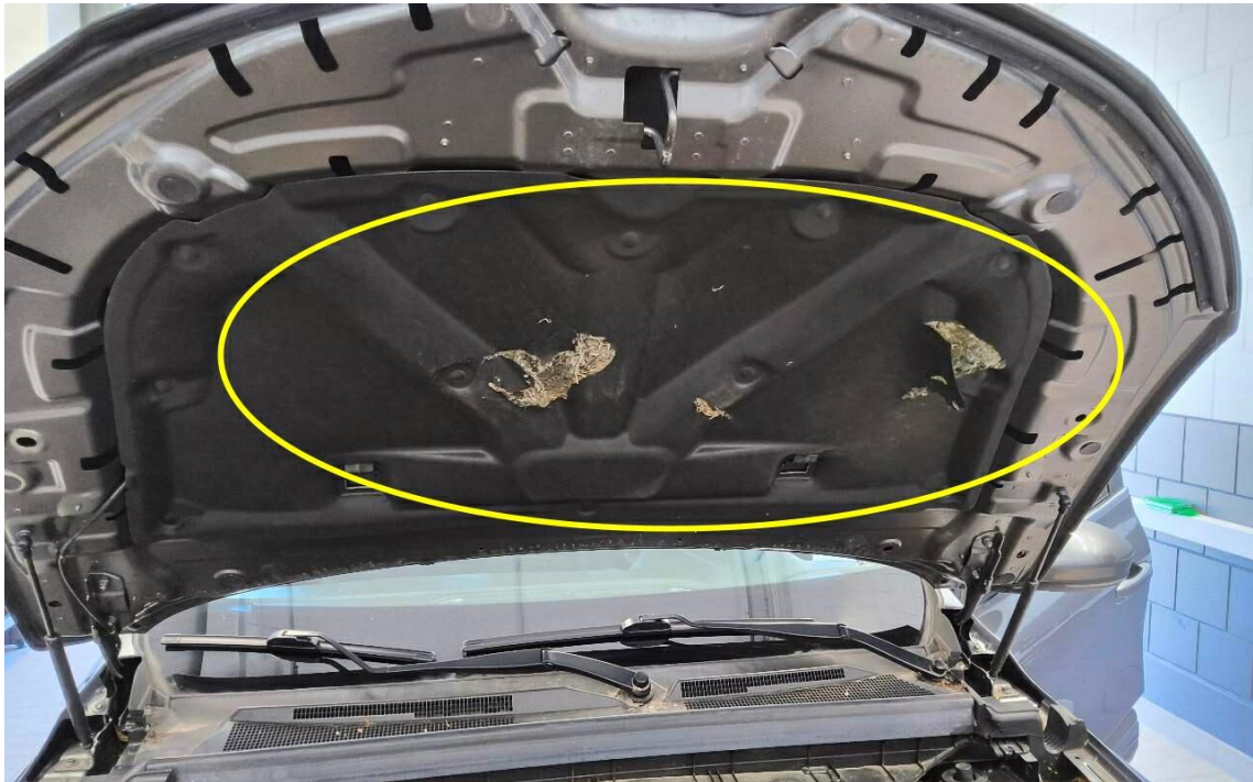
Bild 19 : Motorraum, Dämmungen, gerissen
