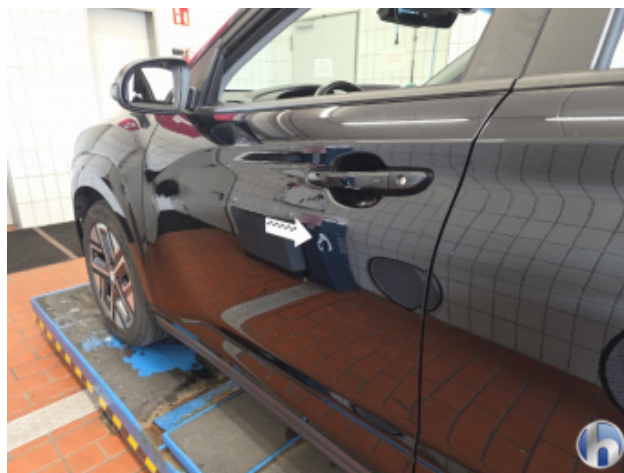
1. Tür Vorne - Links 1 Delle - Sanft Instandsetzen
