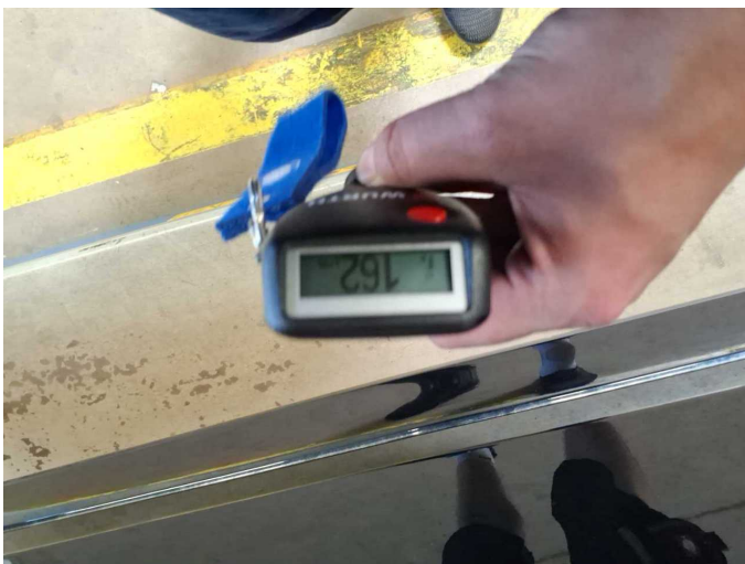
Door - front right side: 162 µm
