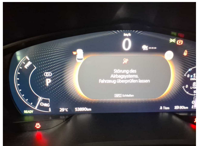
Damage 8: Airbag systems: Airbag system (Störung, Mehrkosten möglich) - on - Perform diagnosis
