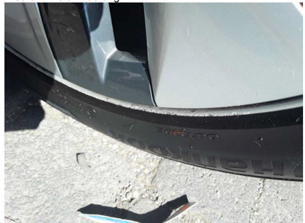
Beschädigung #5: Rad/Reifen: Leichtmetallfelge vorn rechts - Kratzer - erneuern
