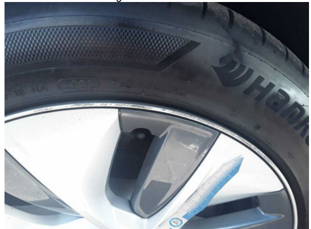
Beschädigung #4: Rad/Reifen: Leichtmetallfelge vorn links - Kratzer - Wertminderung
