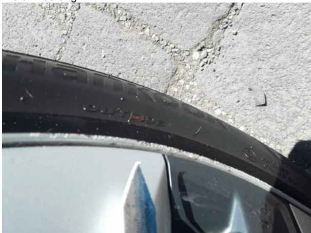
Beschädigung #5: Rad/Reifen: Leichtmetallfelge vorn rechts - Kratzer - erneuern
