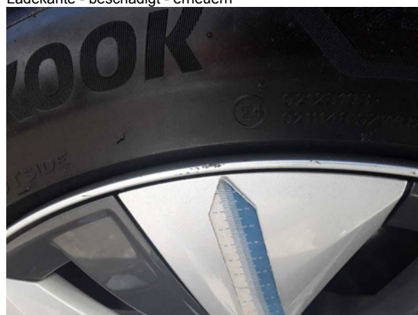
Beschädigung #2: Rad/Reifen: Leichtmetallfelge hinten links - Kratzer - Wertminderung
