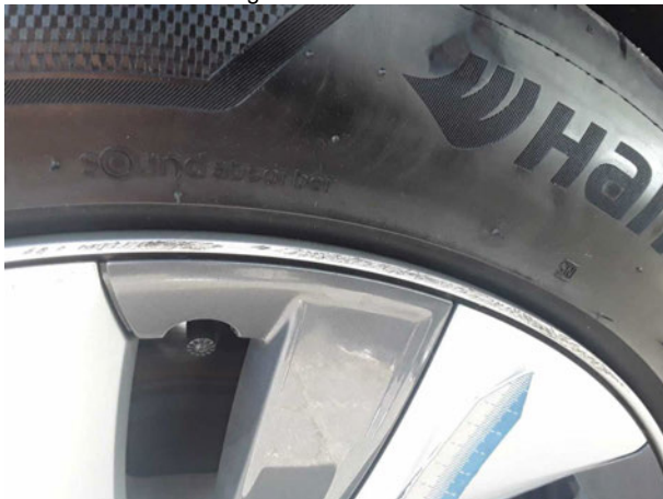
Beschädigung #4: Rad/Reifen: Leichtmetallfelge vorn links - Kratzer - Wertminderung
