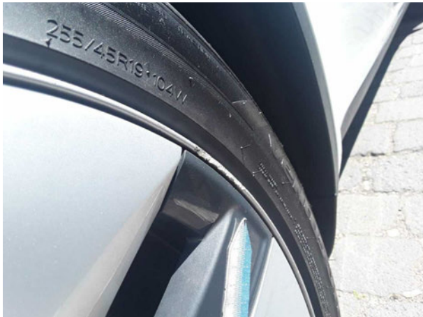
Beschädigung #3: Rad/Reifen: Leichtmetallfelge hinten rechts - Kratzer - Wertminderung
