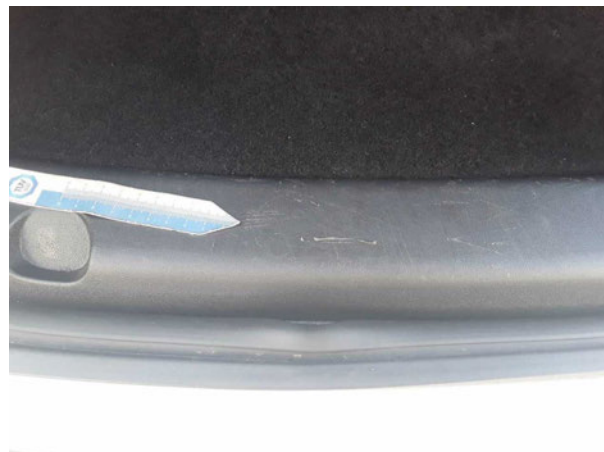
Beschädigung #1: Verkleidungen/Abdeckungen: Verkleidung Ladekante - beschädigt - erneuern
