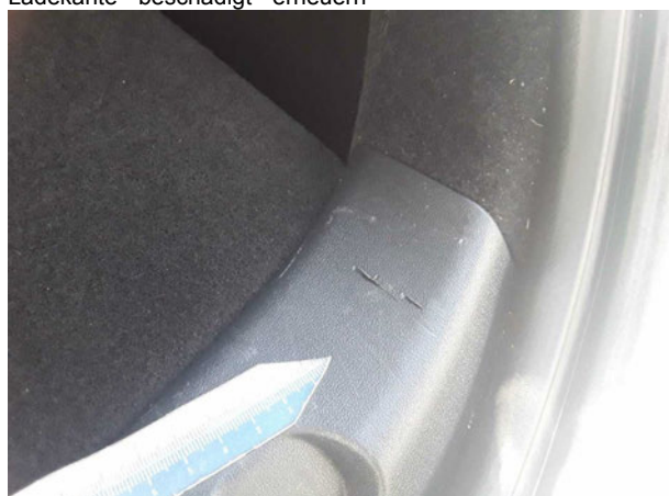
Beschädigung #1: Verkleidungen/Abdeckungen: Verkleidung Ladekante - beschädigt - erneuern
