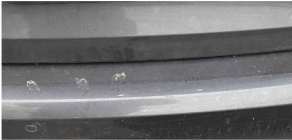
Bild 9 Delle an der Heckklappe unter dem Kennzeichen
