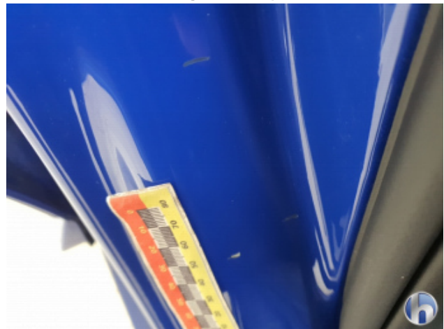
2. Türeinstieg Vorne - Rechts Kratzer Tief Bis Grundierung - Smart Repair
