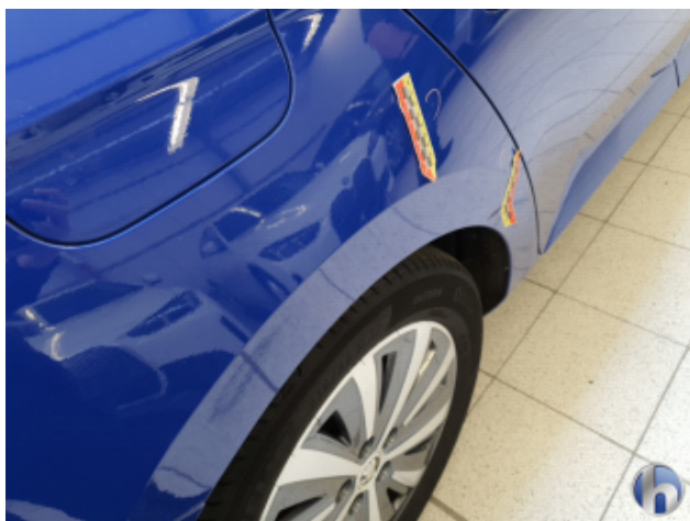
7. Seitenwand - Hinten - Rechts 2 Dellen - Lackieren
