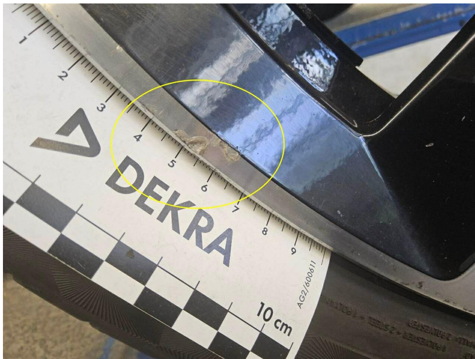
Bild 23 : LM Felge hinten links glanzgedreht verschrammt
