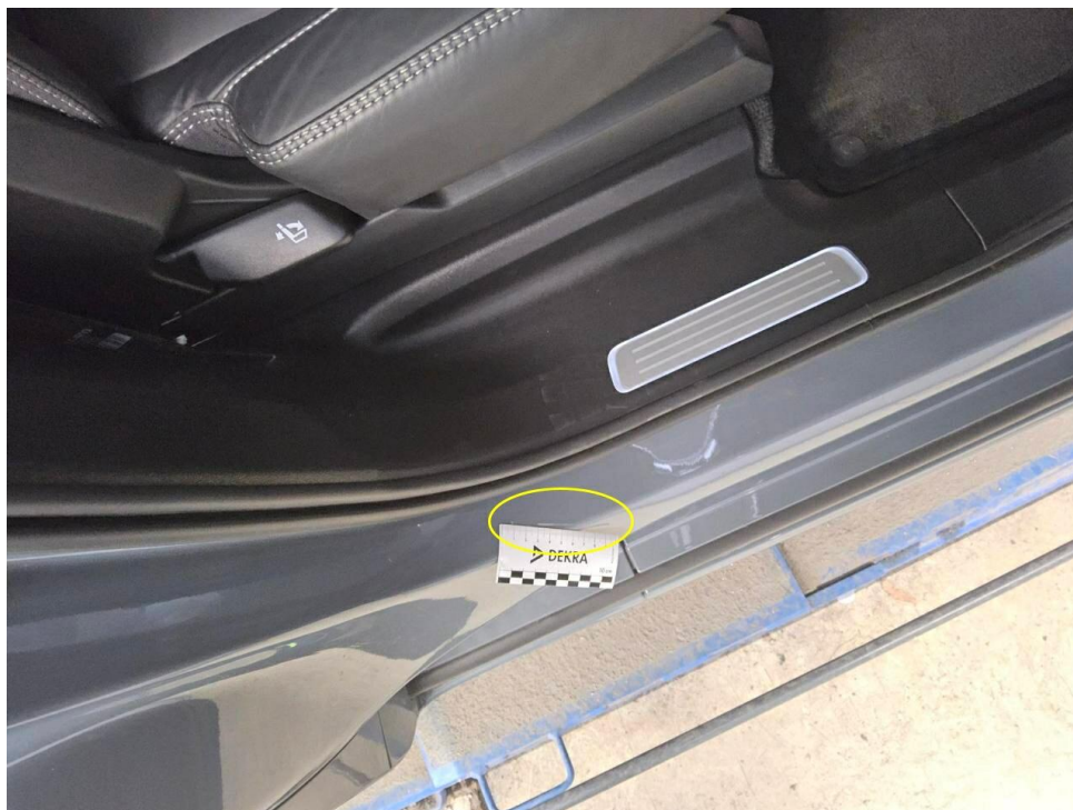
Bild 19 : Tür hinten rechts Einstieg, zerkratzt, smart repair
