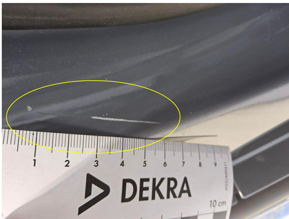
Bild 20 : Tür hinten rechts Einstieg, zerkratzt, smart repair
