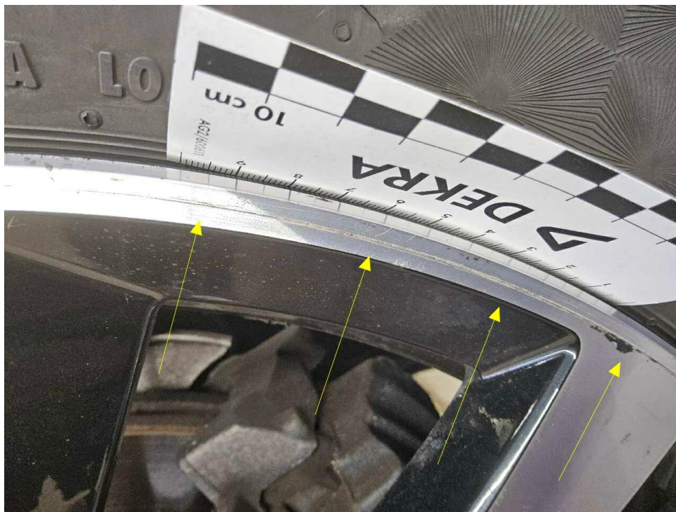
Bild 30 : LM Felge vorne rechts glanzgedreht verschrammt
