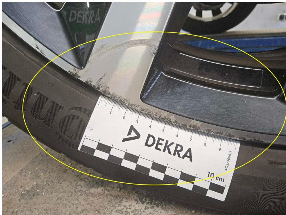
Bild 22 : LM Felge vorne rechts glanzgedreht verschrammt
