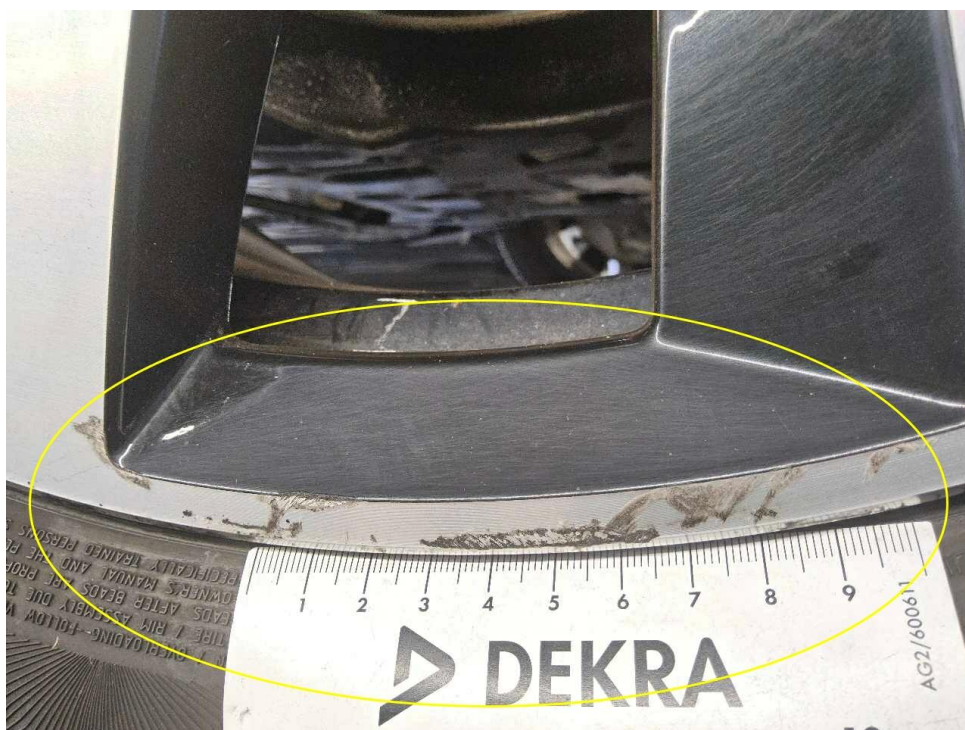
Bild 28 : LM Felge vorne rechts glanzgedreht verschrammt
