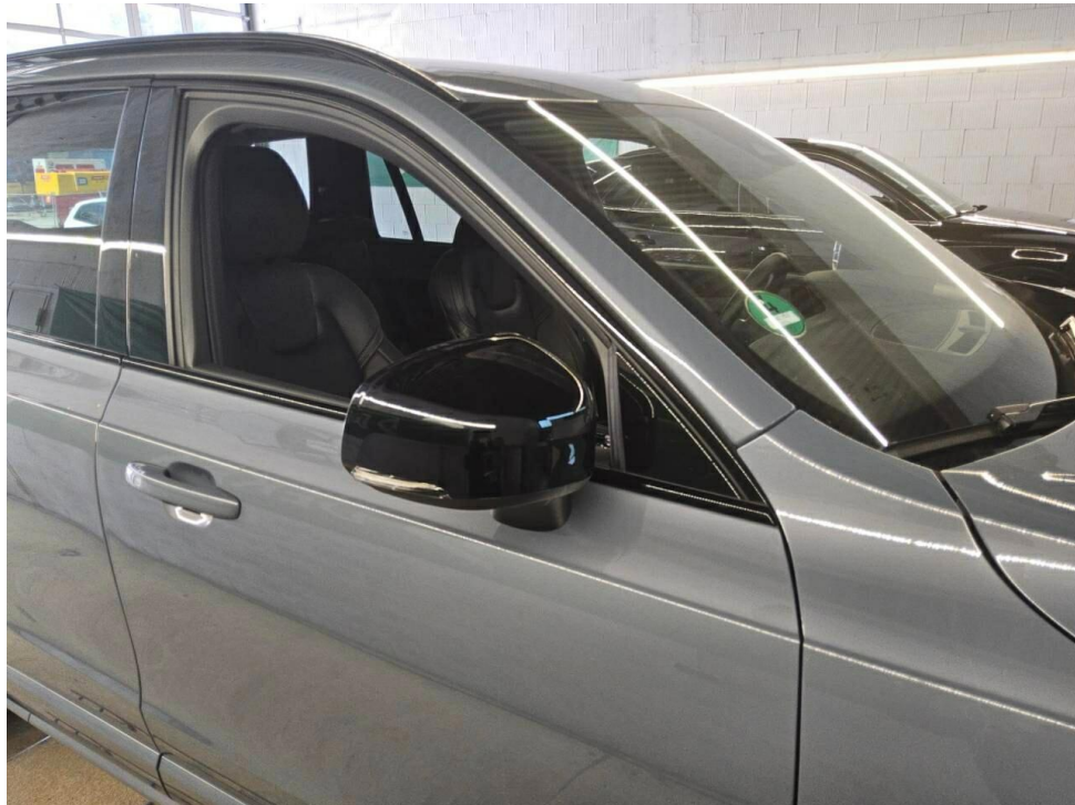
Bild 17 : Außenspiegel rechts Lackierung, zerkratzt, Gebrauchsspur
