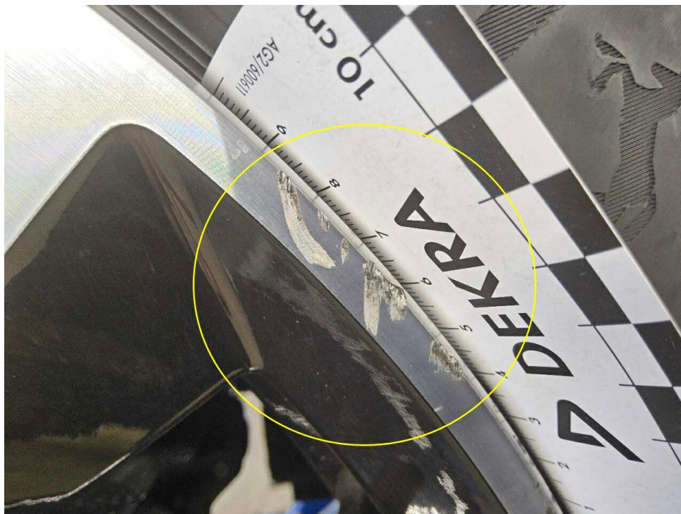
Bild 25 : LM Felge hinten rechts glanzgedreht verschrammt
