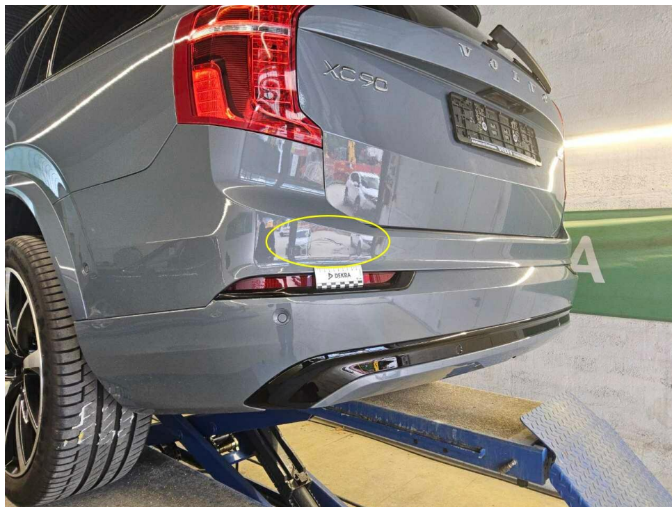
Bild 15 : Stoßfänger hinten Lackierung, verschrammt, lackieren mit Lackaufbau
