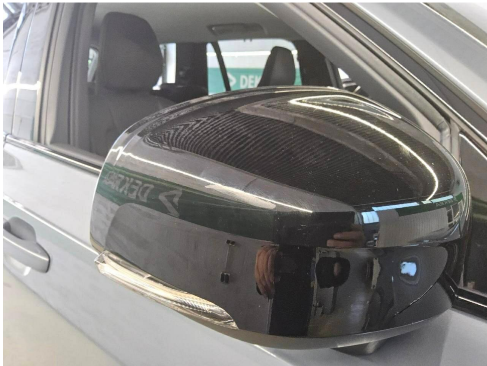
Bild 18 : Außenspiegel rechts Lackierung, zerkratzt, Gebrauchsspur
