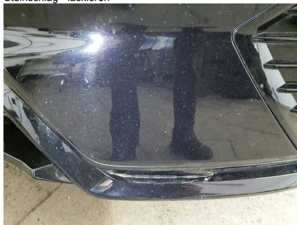
Beschädigung #8: Stossfänger vorn: Stossfänger vorn - Steinschlag - lackieren
