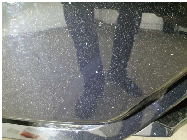
Beschädigung #8: Stossfänger vorn: Stossfänger vorn - Steinschlag - lackieren
