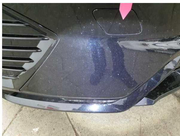
Beschädigung #8: Stossfänger vorn: Stossfänger vorn - Steinschlag - lackieren
