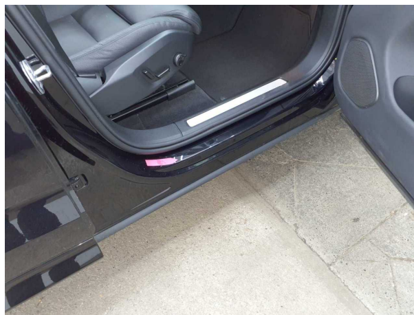
Beschädigung #7: Schweller rechts: Einstieg - Kratzer - lackieren
