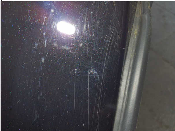
Beschädigung #1: Seitenwand links: Einstieg - Kratzer - auslegen / polieren
