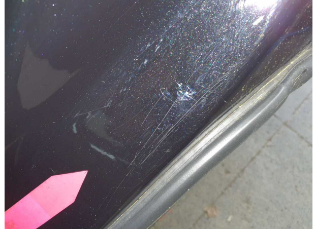
Beschädigung #1: Seitenwand links: Einstieg - Kratzer - auslege... polieren
