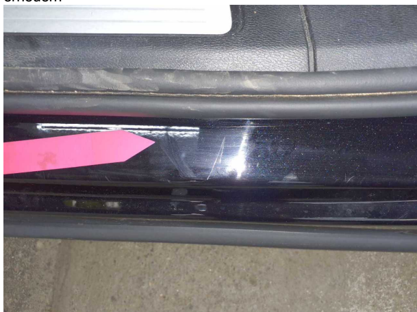
Beschädigung #6: Schweller links: Einstieg - Kratzer - lackieren
