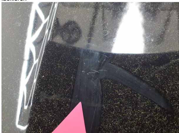
Beschädigung #9: Motorhaube: Motorhaube - Delle / Lackschaden - instandsetzen und lackieren
