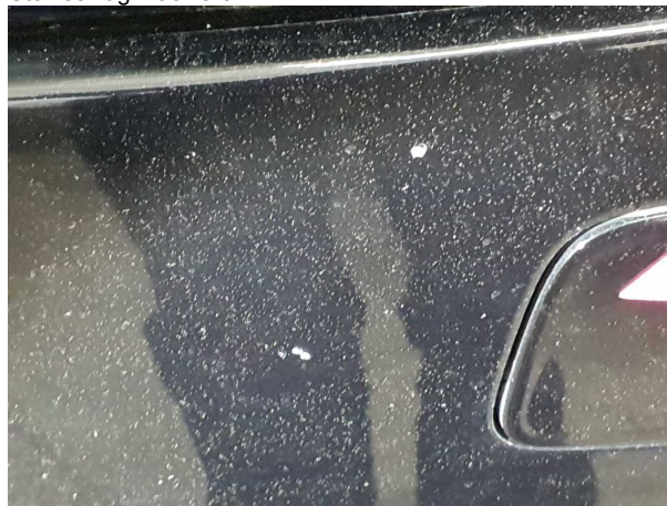
Beschädigung #8: Stossfänger vorn: Stossfänger vorn - Steinschlag - lackieren
