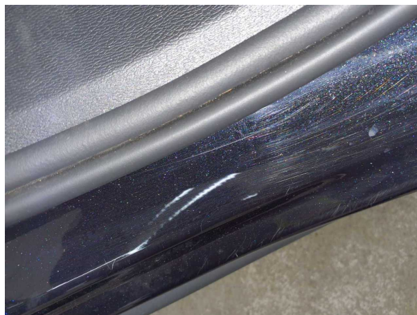
Beschädigung #6: Schweller links: Einstieg - Kratzer - lackieren
