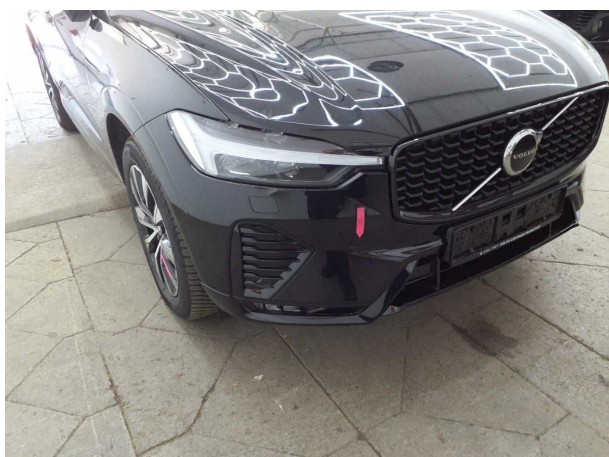
Beschädigung #8: Stossfänger vorn: Stossfänger vorn - Steinschlag - lackieren
