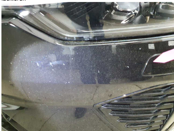
Beschädigung #8: Stossfänger vorn: Stossfänger vorn - Steinschlag - lackieren
