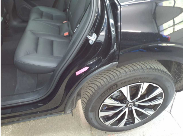
Beschädigung #1: Seitenwand links: Einstieg - Kratzer - auslegen / polieren
