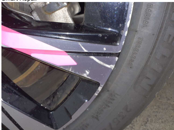
Beschädigung #5: Rad/Reifen: Leichtmetallfelge vorn rechts - Kratz... erneuern
