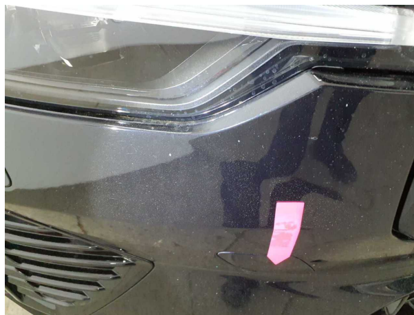
Beschädigung #8: Stossfänger vorn: Stossfänger vorn - Steinschlag - lackieren
