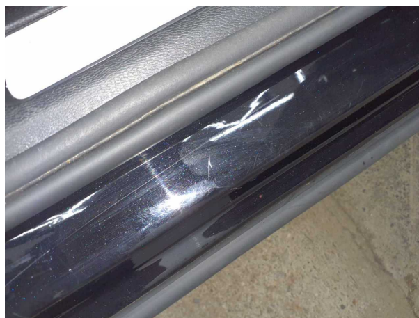
Beschädigung #7: Schweller rechts: Einstieg - Kratzer - lackieren
