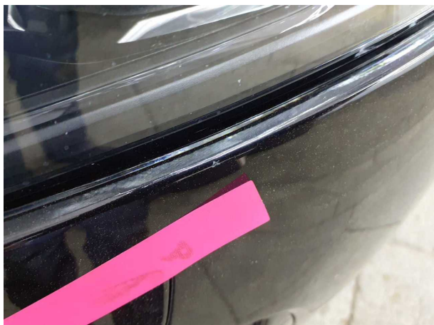
Beschädigung #8: Stossfänger vorn: Stossfänger vorn - Steinschlag - lackieren
