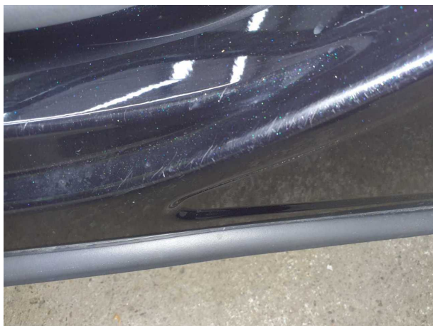
Beschädigung #6: Schweller links: Einstieg - Kratzer - lackieren
