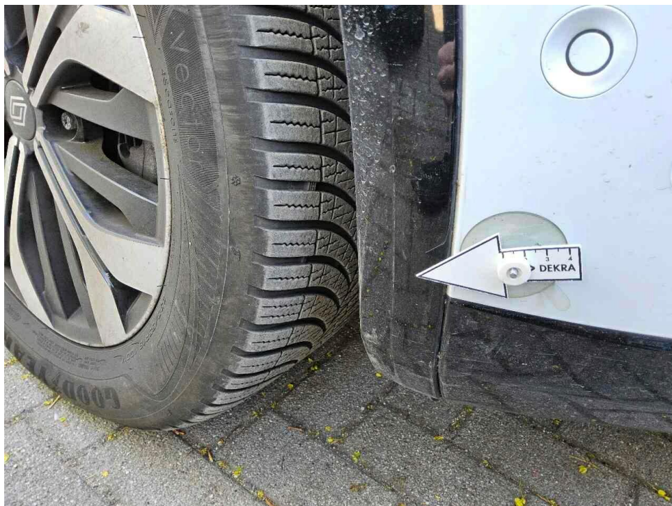
Bild 16 : Kotflügel vorne rechts Zierleiste Lackierung, zerkratzt, smart repair
