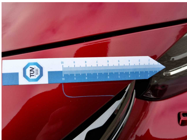
Beschädigung #4: Stossfänger vorn: Stossfänger vorn (Abdeckung O-Gtill) - Kratzer - lackieren
