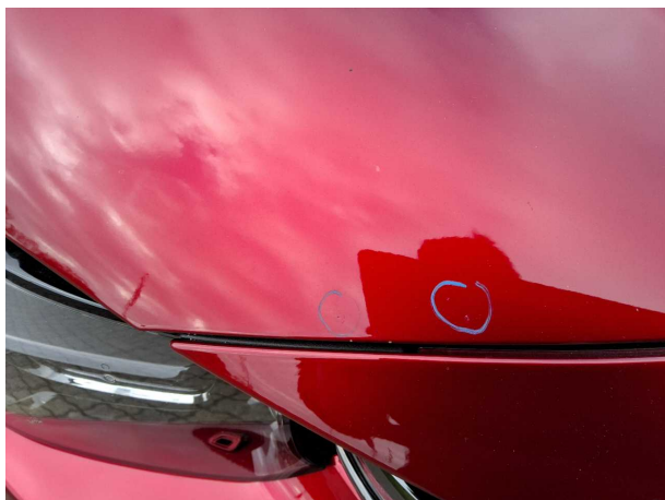
Beschädigung #3: Motorhaube: Motorhaube - Steinschlag - auslege... polieren
