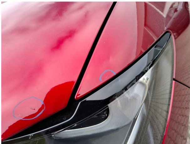
Beschädigung #3: Motorhaube: Motorhaube - Steinschlag - auslege... polieren
