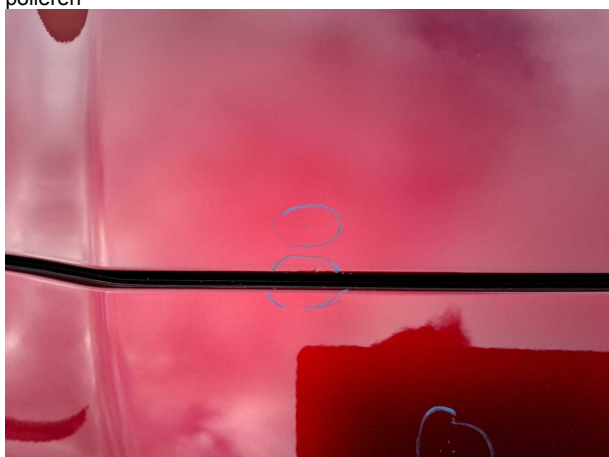
Beschädigung #3: Motorhaube: Motorhaube - Steinschlag - auslege... polieren
