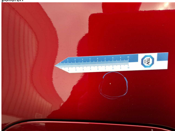
Beschädigung #3: Motorhaube: Motorhaube - Steinschlag - auslege... polieren
