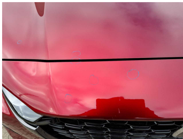
Beschädigung #3: Motorhaube: Motorhaube - Steinschlag - auslegen / polieren
