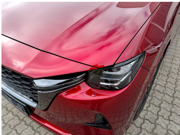
Beschädigung #1: Kotflügel links: Kotflügel links - Steinschlag - auslegen / polieren
