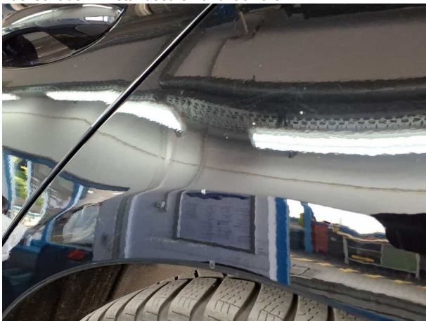
Beschädigung #2: Seitenwand links: Seitenwand - Delle / Lackschaden - instandsetzen und lackieren
