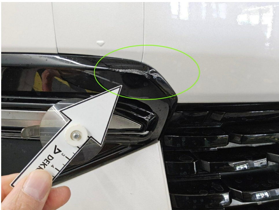
Bild 8 : Stoßfänger vorne Blende rechts, zerkratzt
