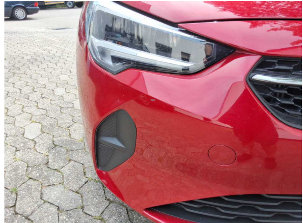
Beschädigung #1: Stossfänger vorn: Stossfänger vorn - Kratzer - instandsetzen und lackieren
