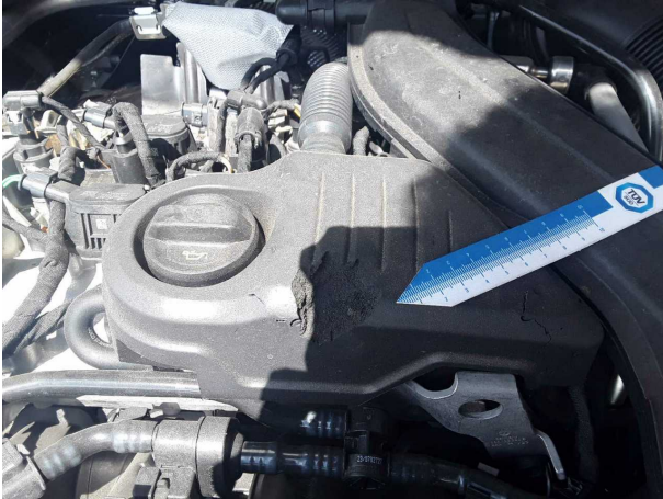
Beschädigung #2: Motorhaube: Dämmmatte - Kratzer - erneuern
