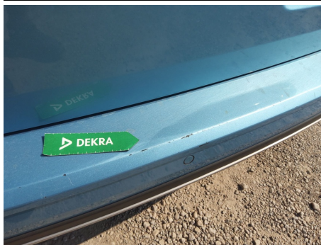
Paragolpes / Trasero / Abolladura
