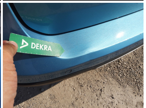
Paragolpes / Trasero / Abolladura
