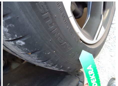
Neumático / Trasero izquierdo / Desgarro
