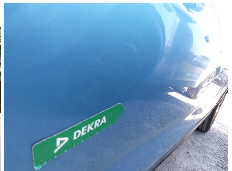
Puerta / Delantero Izquierdo / Abolladura
