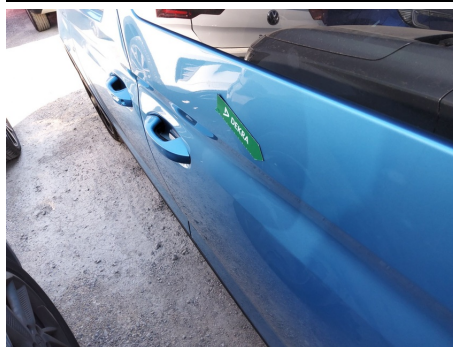
Puerta / Trasero Izquierdo / Abolladura
