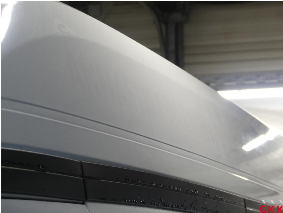
Bild 16 Fahrzeug, außen, Lackierung verwittert / matt, aufbereiten
