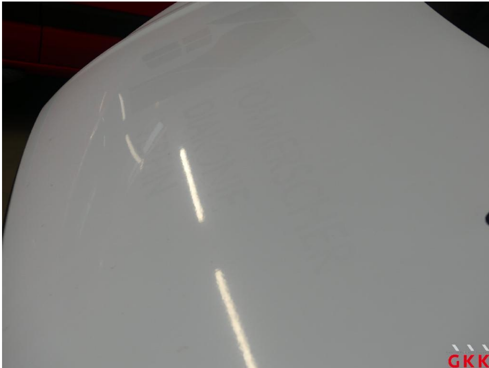
Bild 15 Fahrzeug, außen, Lackierung verwittert / matt, aufbereiten
