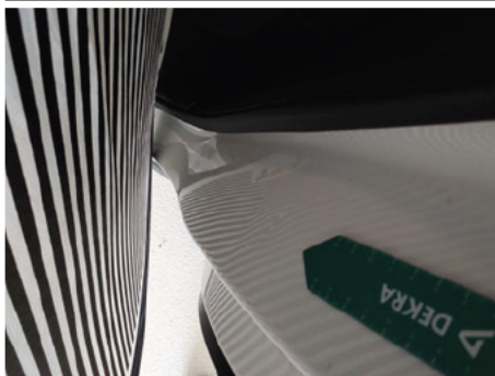
Türeinstieg / Hinten Links / Delle
