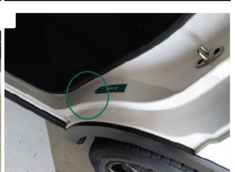
Türeinstieg / Hinten Links / Delle
