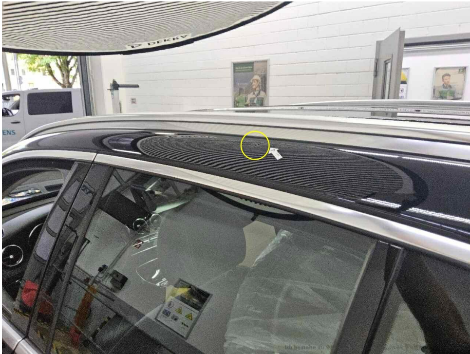
Bild 29 : Dachrahmen links, eingedellt
