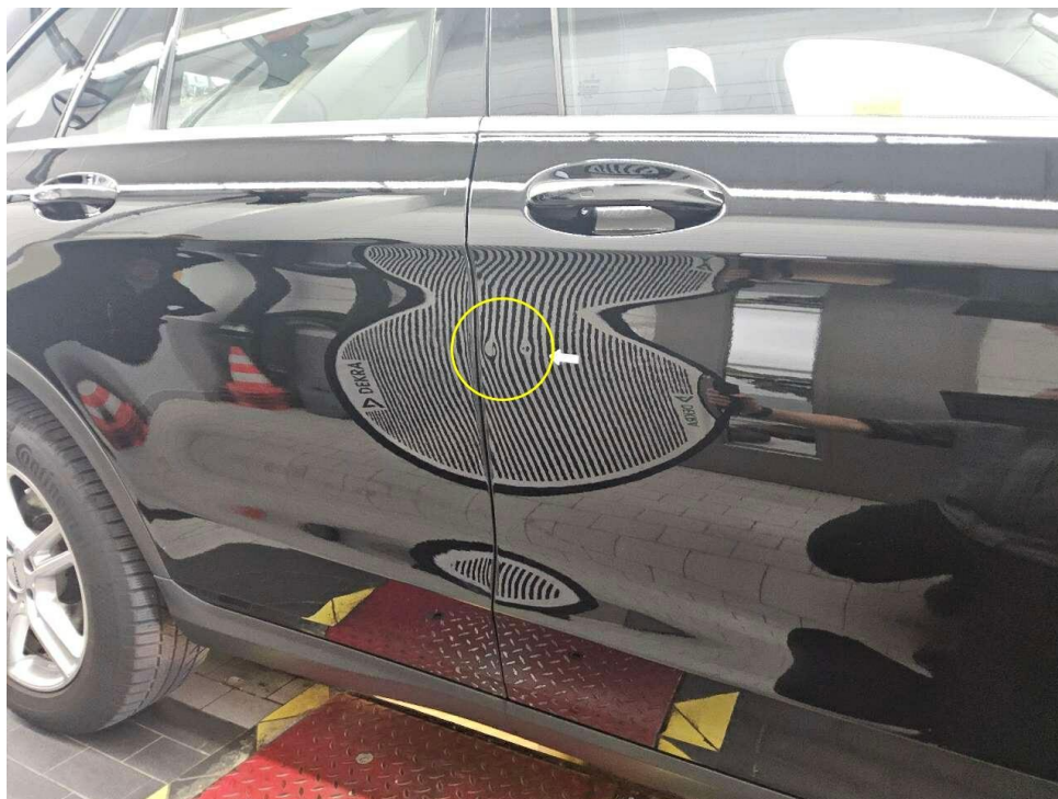
Bild 25 : Tür vorne rechts, eingedellt
