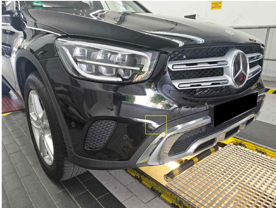
Bild 15 : Stoßfänger vorne Lackierung, zerkratzt, lackieren mit Lackaufbau
