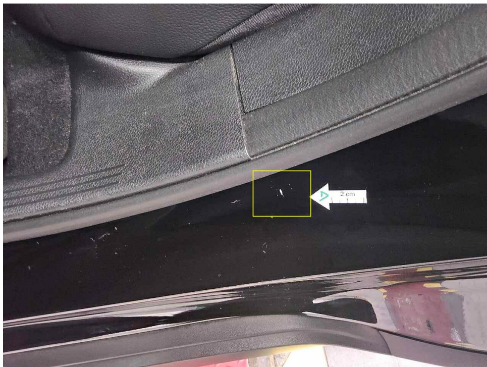
Bild 32 : Tür hinten links Einstieg, zerkratzt
