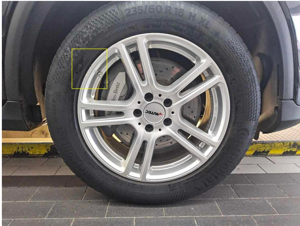
Bild 35 : Felge (Winter) vorne rechts, zerkratzt
