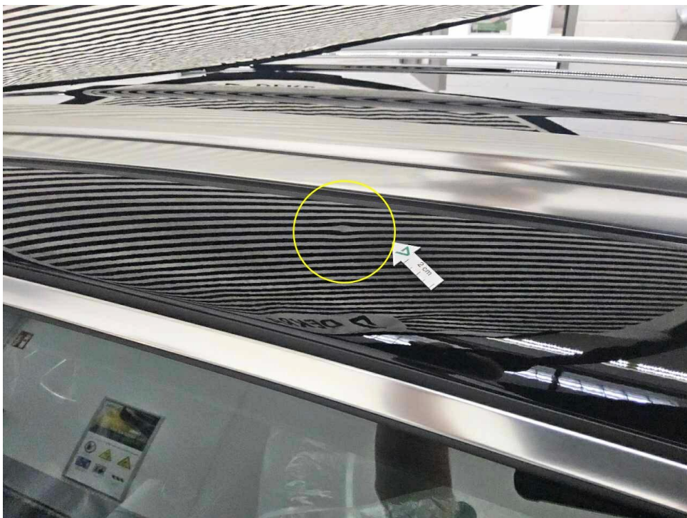
Bild 30 : Dachrahmen links, eingedellt
