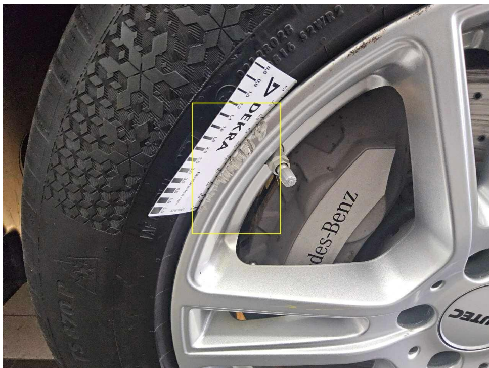
Bild 36 : Felge (Winter) vorne rechts, zerkratzt
