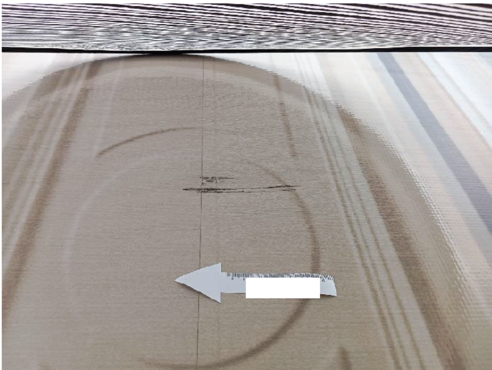
Bild: 34 Seitenwand Kühlkofferaufbau rechts deformiert
