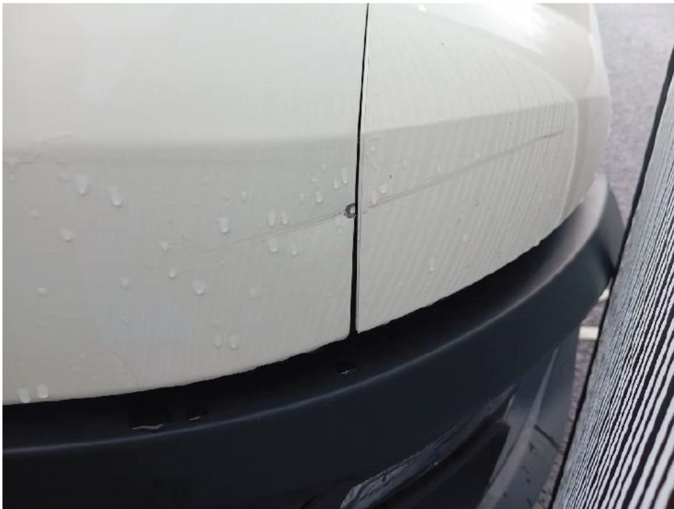
Bild: 13 Stoßfänger vorne rechts oben deformiert
