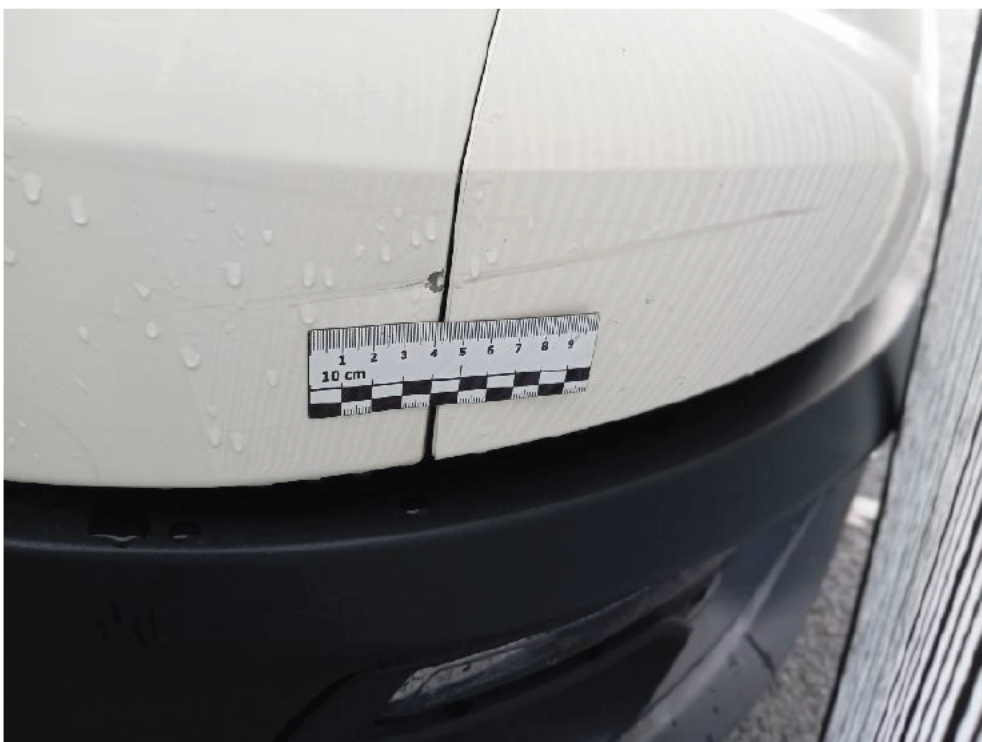
Bild: 14 Kotflügel vorne rechts deformiert
