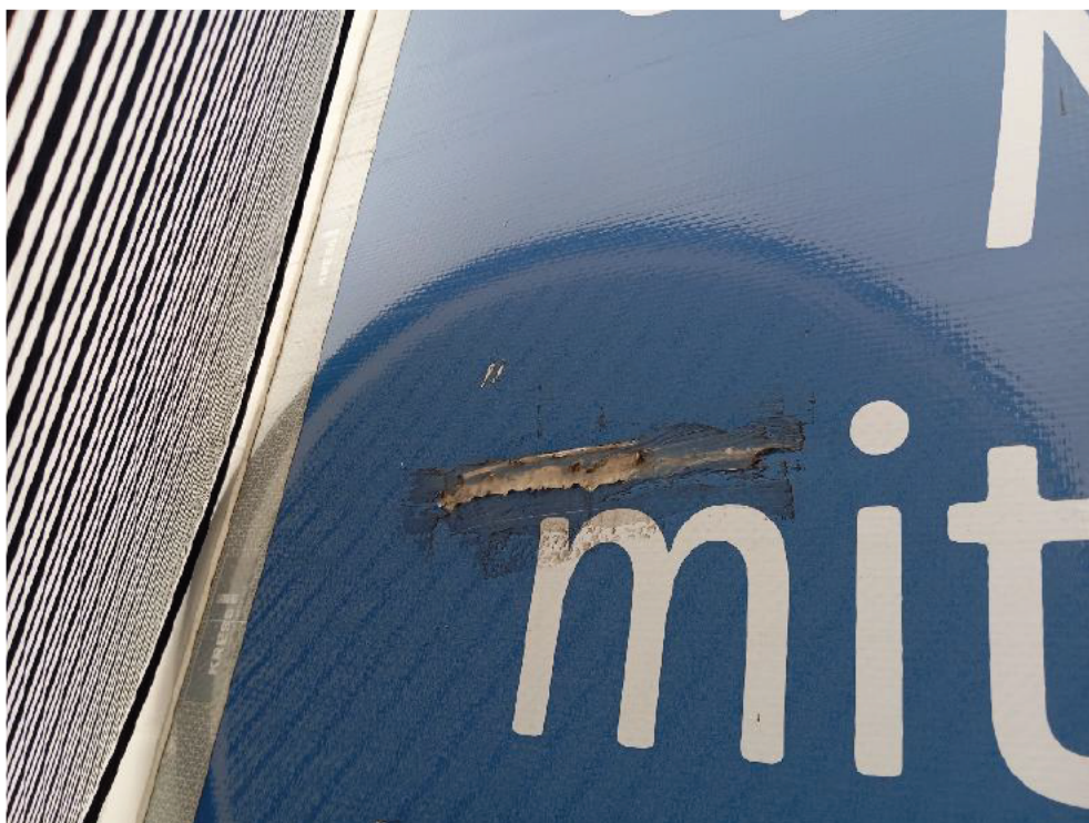
Bild: 32 Seitenwand Kühlkofferaufbau rechts deformiert
