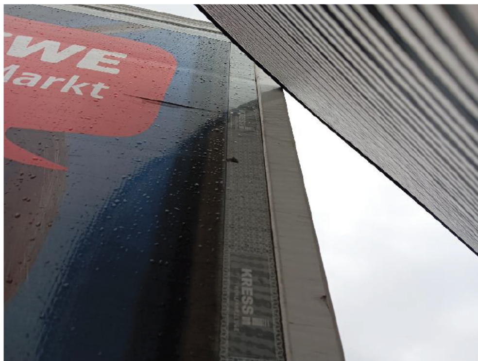
Bild: 26 Seitenwand Kühlkofferaufbau links deformiert
