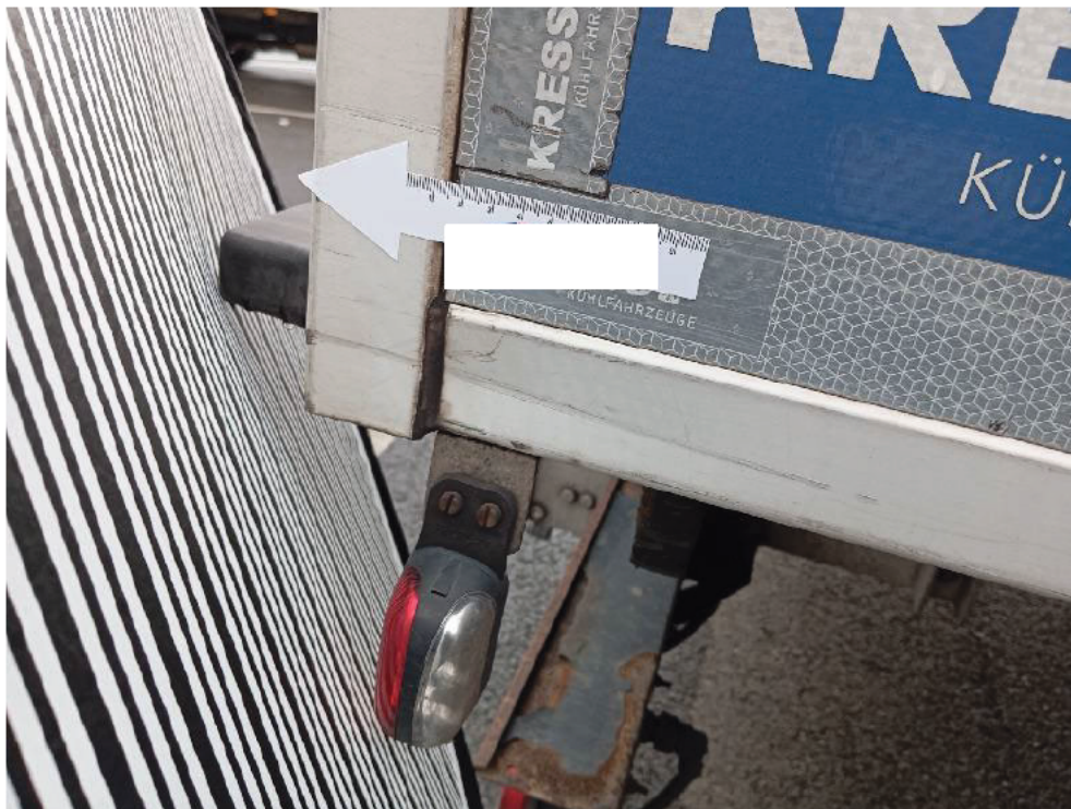
Bild: 31 Seitenwand Kühlkofferaufbau rechts deformiert
