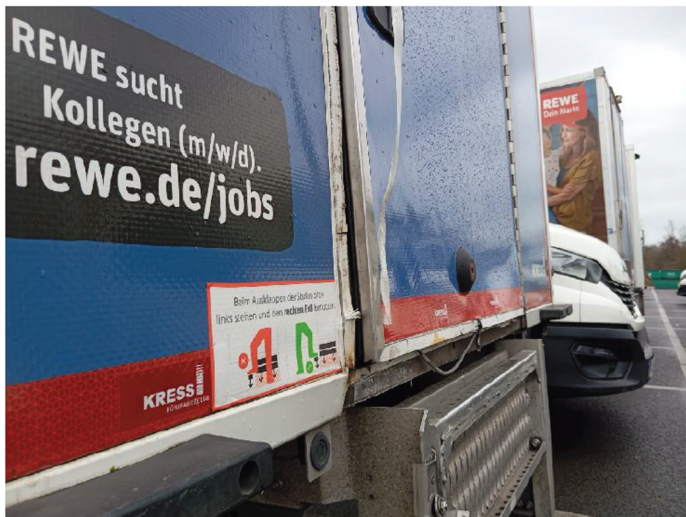
Bild: 44 Tür/Rahmen Kühlkoffer deformiert
