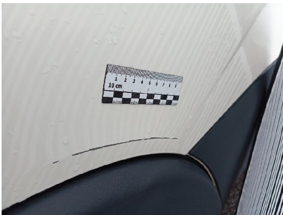
Bild: 16 Tür links deformiert
