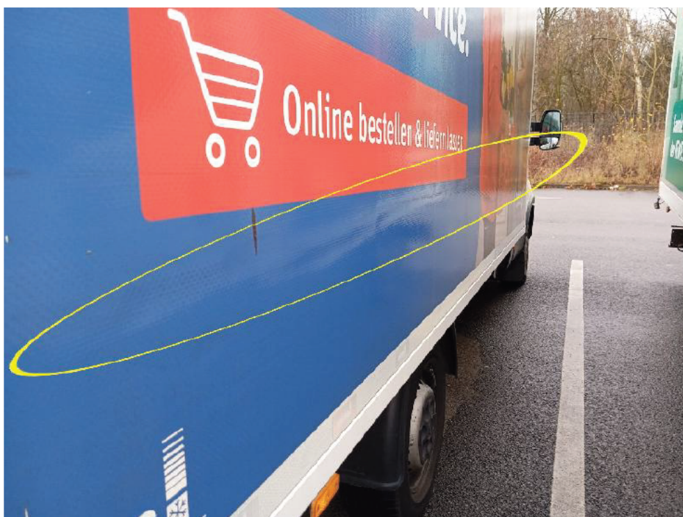
Bild: 38 Seitenwand Kühlkofferaufbau rechts deformiert
