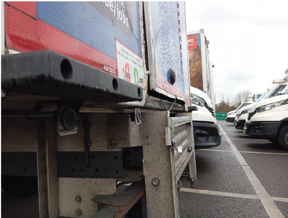
Bild: 43 Rahmen Kühlkoffer deformiert
