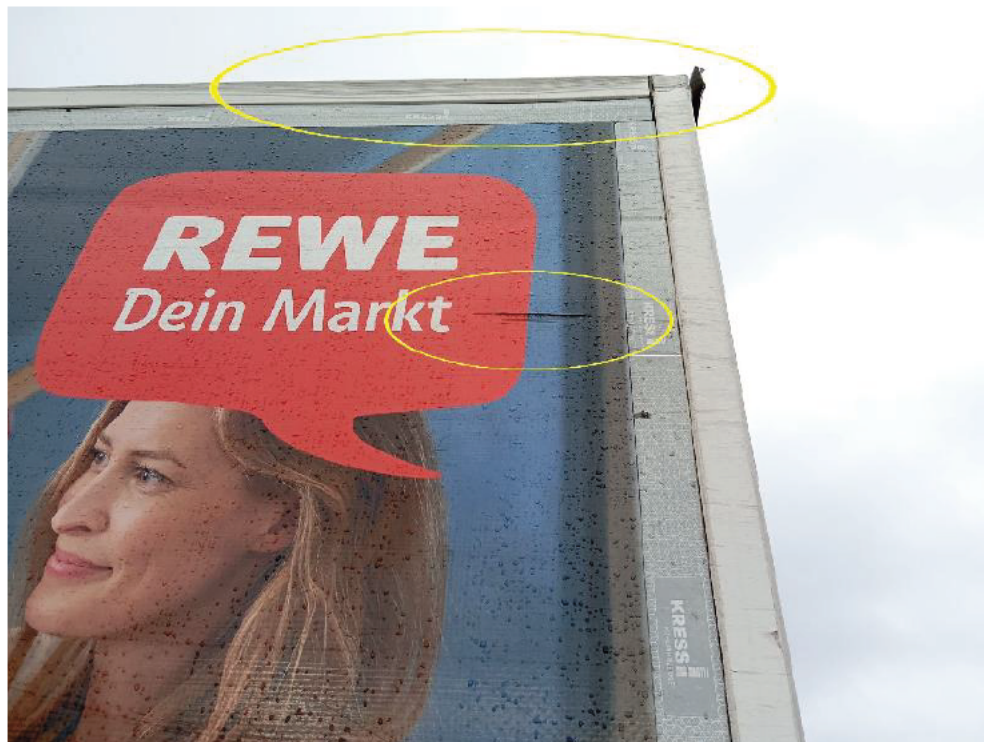
Bild: 25 Seitenwand/Dachholm Kühlkofferaufbau links deformiert
