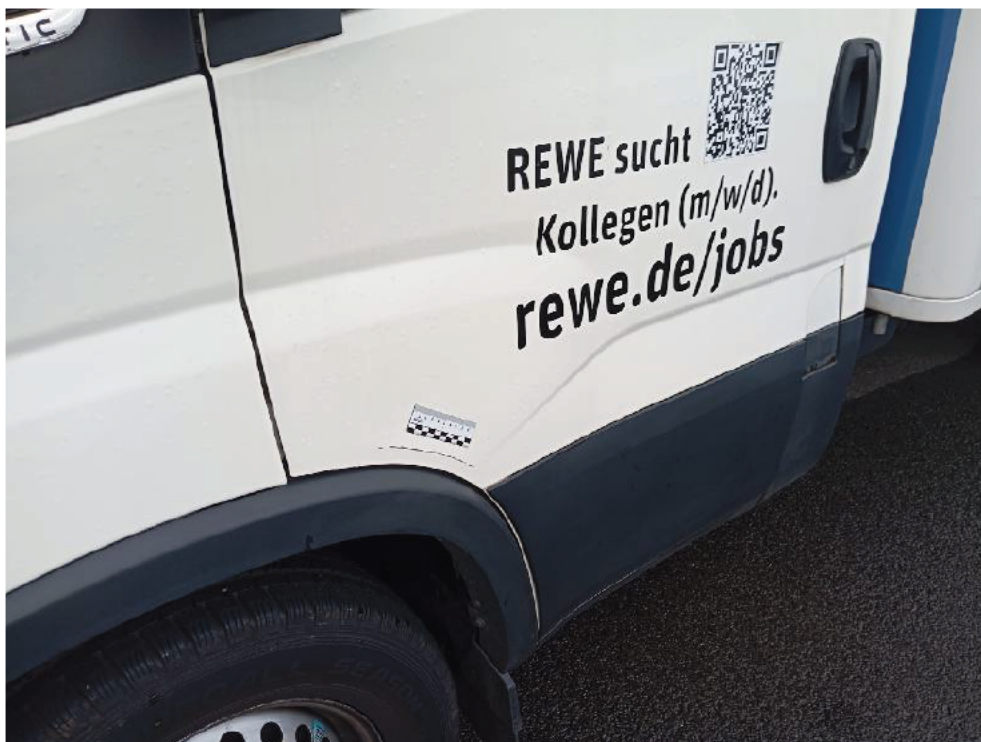
Bild: 15 Tür links deformiert
