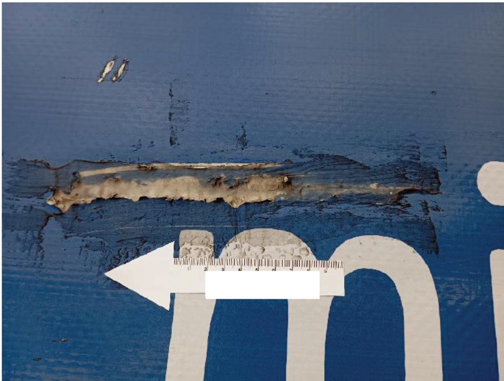
Bild: 33 Seitenwand Kühlkofferaufbau rechts deformiert
