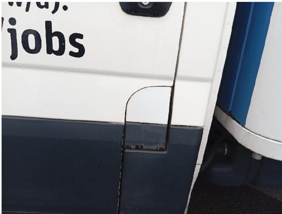
Bild: 17 Tür links deformiert
