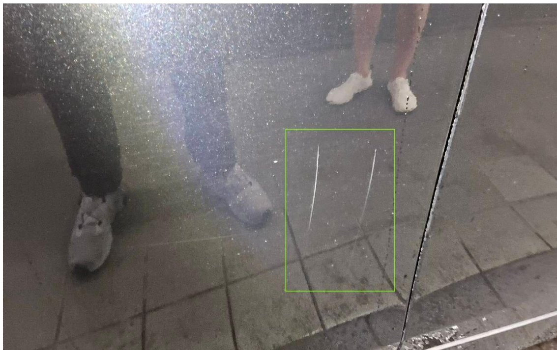
Bild 13 : Beifahrertür vorne rechts zerkratzt
