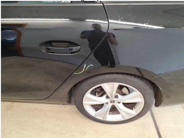
Beschädigung #5: Seitenwand links: Seitenwand - Delle / Lackschaden - Smart Repair
