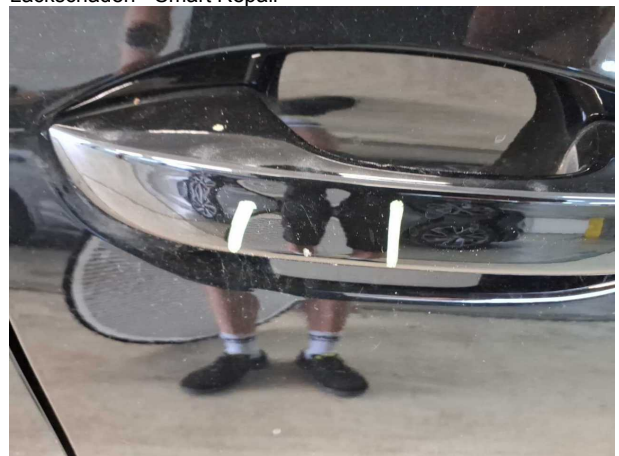
Beschädigung #6: Tür vorn rechts: Griff außen - verkratzt / verschürft - Smart Repair
