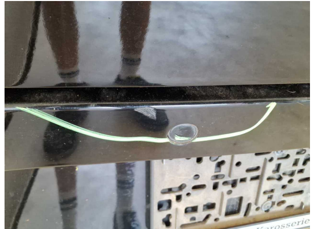
Beschädigung #2: Stossfänger hinten: Stossfänger hinten - verkratzt / verschürft - auslegen / polieren
