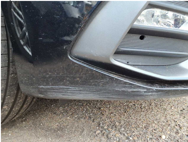
Beschädigung #8: Stoßfänger vorn: Stoßfänger vorn - verkratzt / verschürft - Smart Repair
