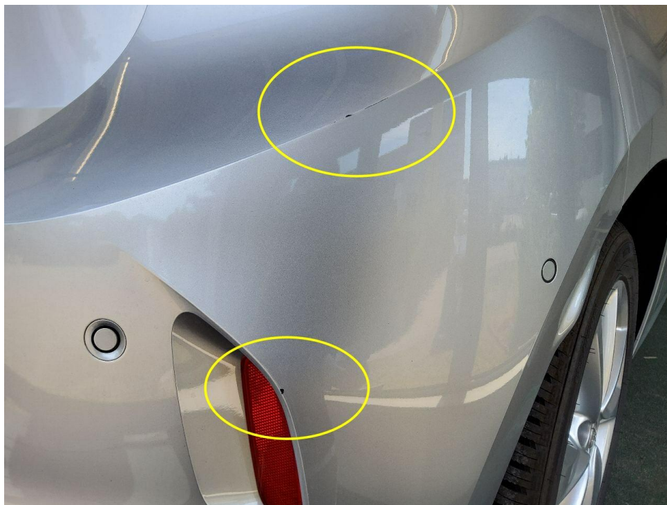
Bild 23 : Stoßfänger hinten Lackierung, verschrammt, lackieren mit Lackaufbau
