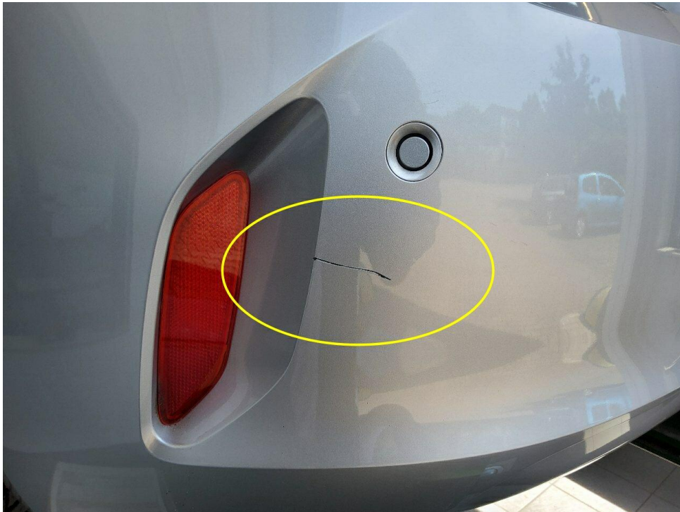
Bild 24 : Stoßfänger hinten Lackierung, verschrammt, lackieren mit Lackaufbau
