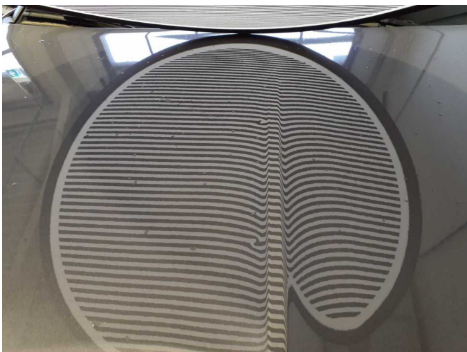
Damage 8: Bonnet: Bonnet (Verätzung) - Paint defect - Paint
