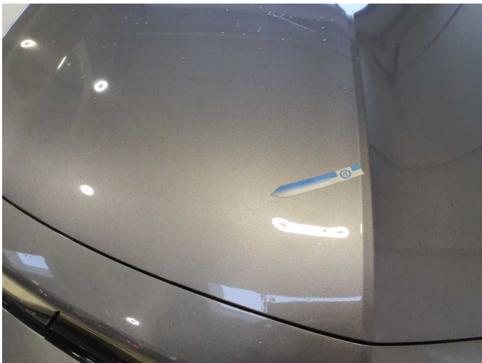
Damage 8: Bonnet: Bonnet (Verätzung) - Paint defect - Paint
