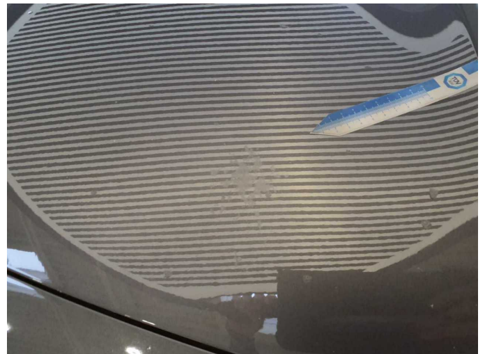
Damage 8: Bonnet: Bonnet (Verätzung) - Paint defect - Paint
