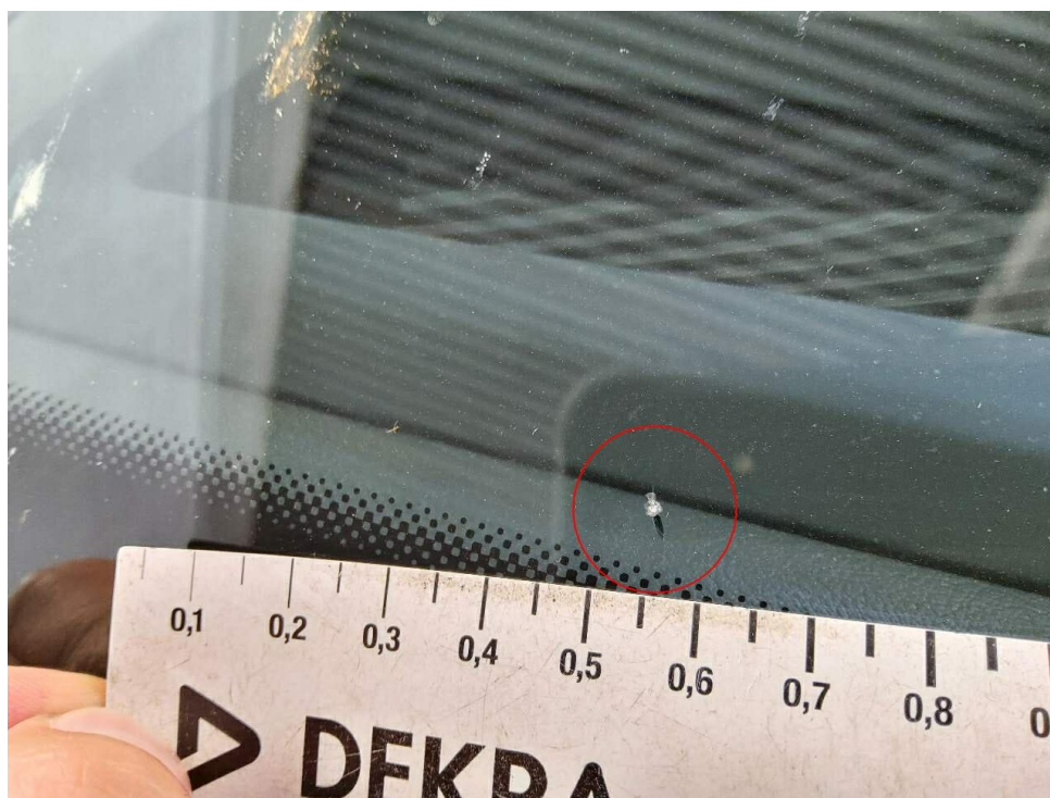
Bild 16 : Frontscheibe Steinschlag mit Rissbildung
