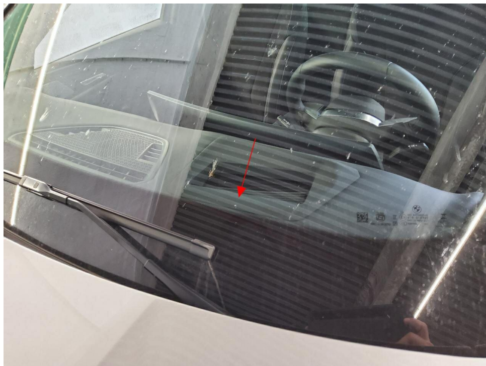
Bild 15 : Frontscheibe Steinschlag mit Rissbildung
