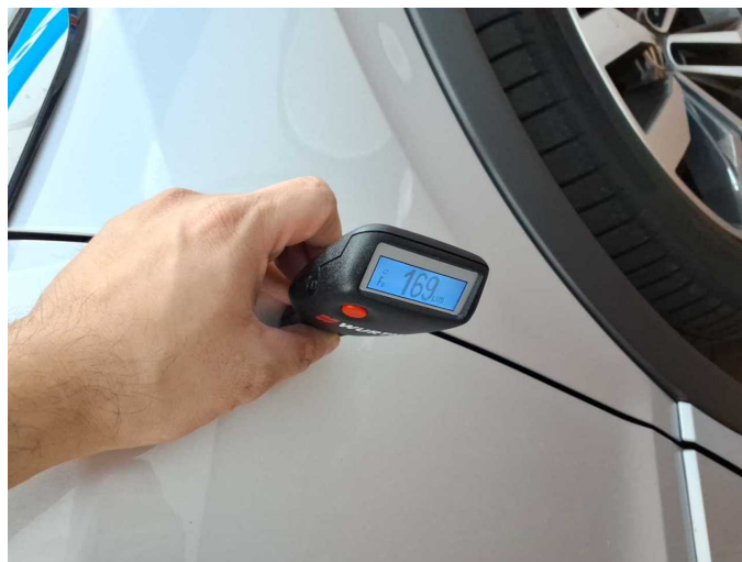
Door - front right side: 169 µm
