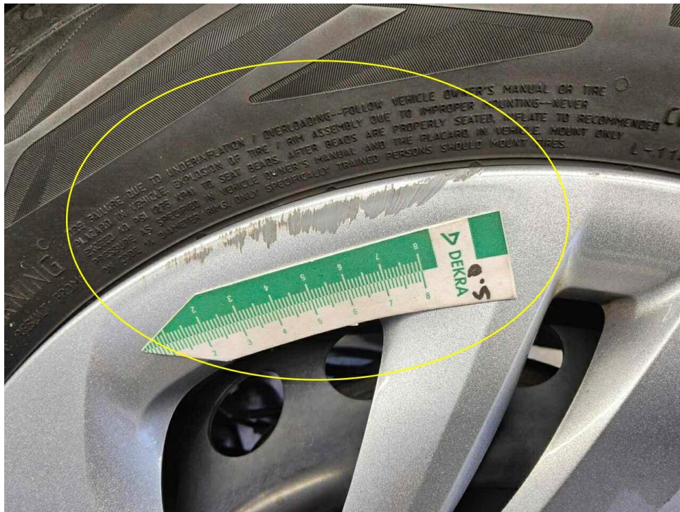
Bild 19 : Radzierblende hinten links verschrammt
