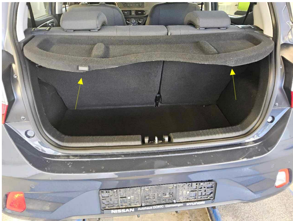
Bild 37 : Kofferraumabdeckung, Anschlaggummi fehlt
