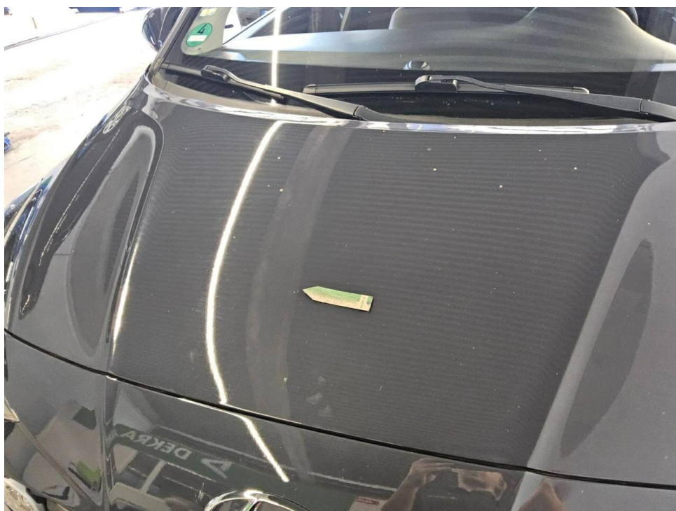
Bild 16 : Motorhaube Lackierung, Steinschlag, Gebrauchsspur
