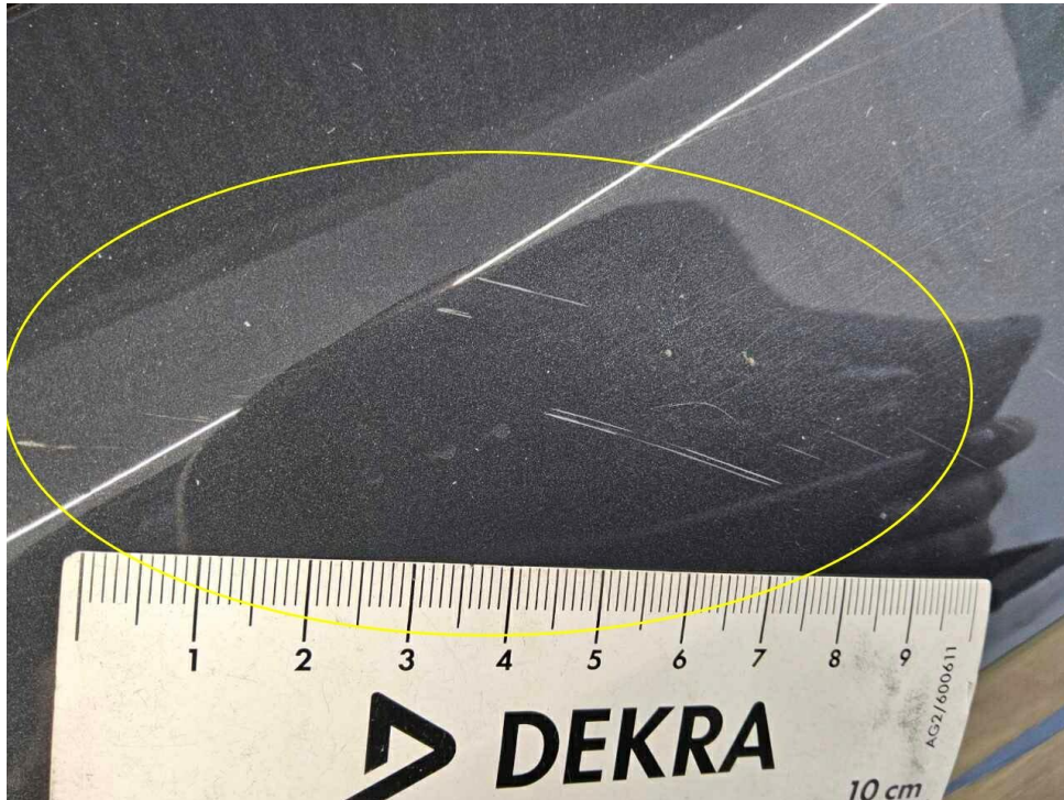
Bild 21 : Tür hinten links Lackierung, verschrammt, lackieren mit Lackaufbau
