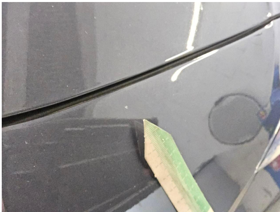
Bild 15 : Stoßfänger vorne Lackierung, Steinschlag, Gebrauchsspur
