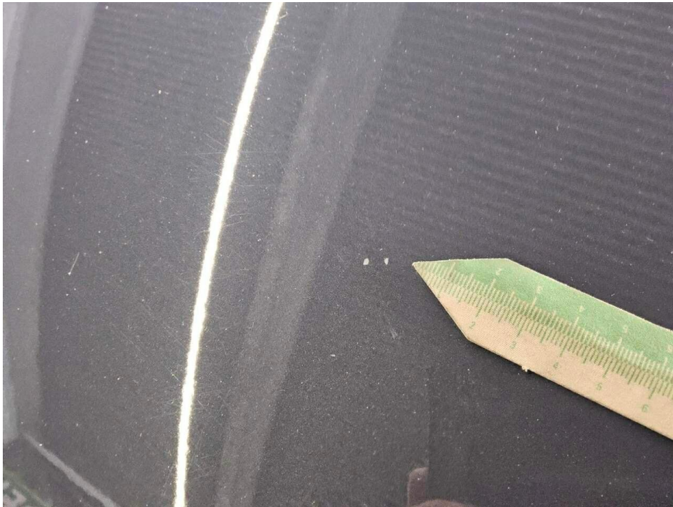
Bild 17 : Motorhaube Lackierung, Steinschlag, Gebrauchsspur
