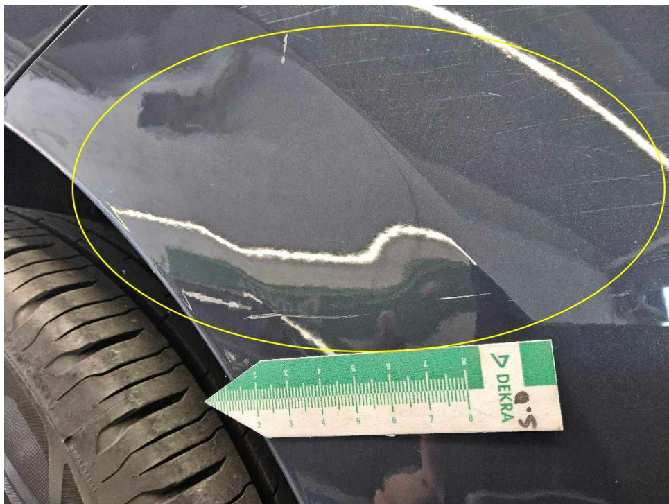
Bild 24 : Schaden Stoßfänger vorne rechts
