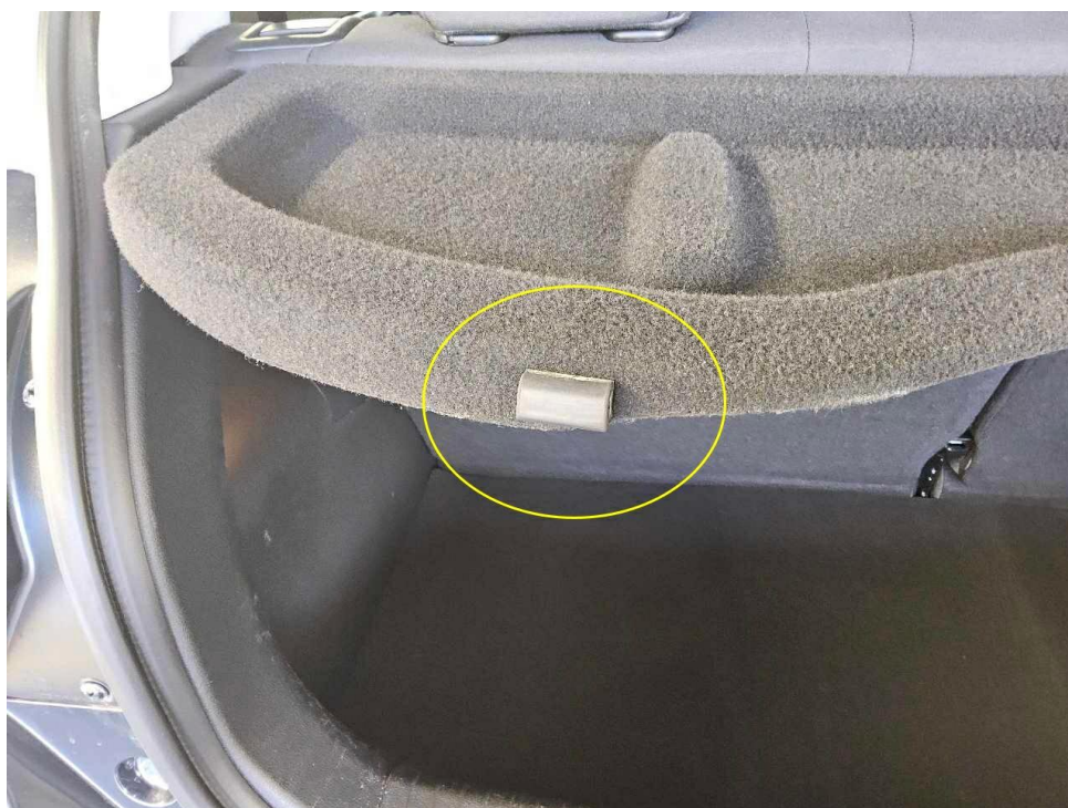
Bild 36 : Kofferraumabdeckung, Anschlaggummi fehlt
