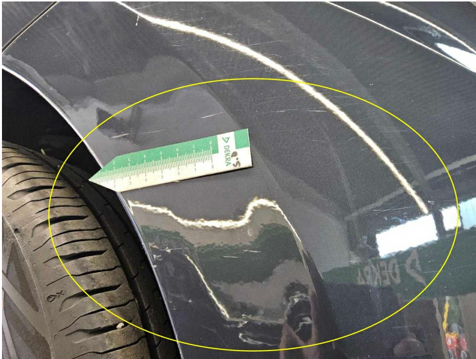
Bild 25 : Schaden Stoßfänger vorne rechts
