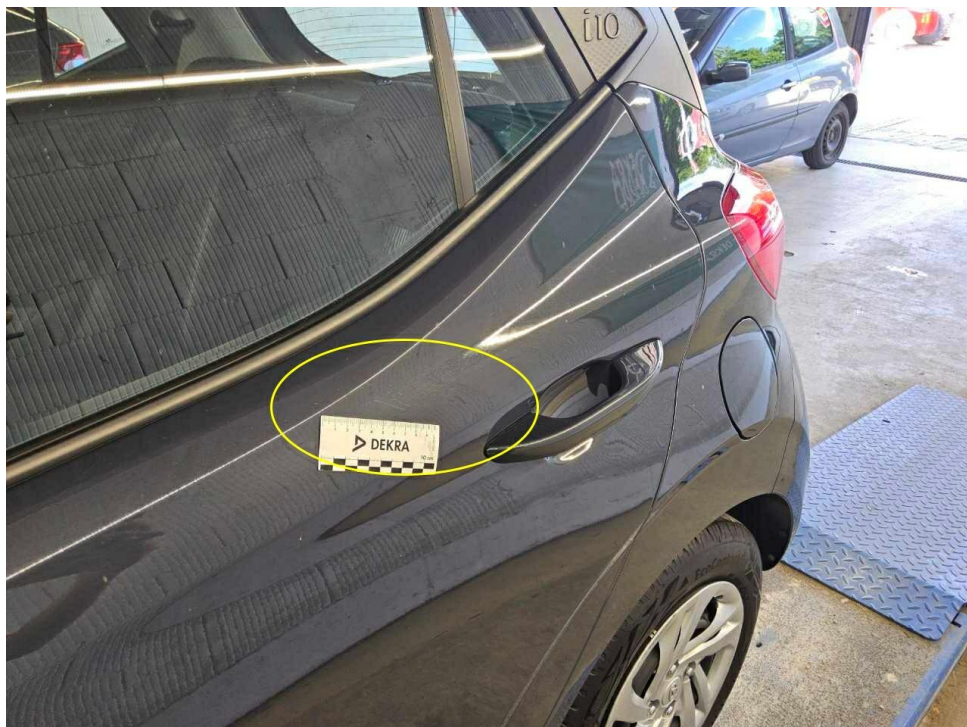
Bild 20 : Tür hinten links Lackierung, verschrammt, lackieren mit Lackaufbau
