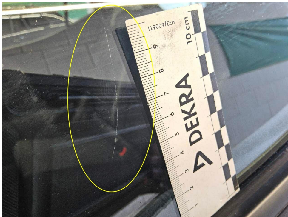
Bild 32 : Türe hinten links, Scheibe zerkratzt
