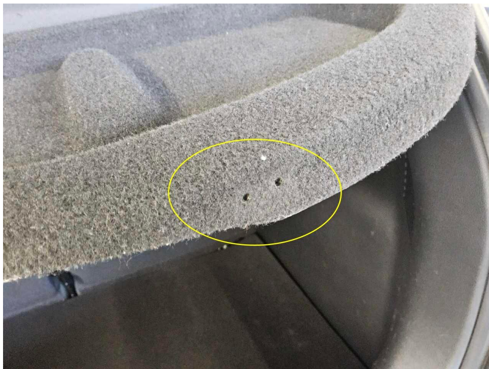
Bild 35 : Kofferraumabdeckung, Anschlaggummi fehlt
