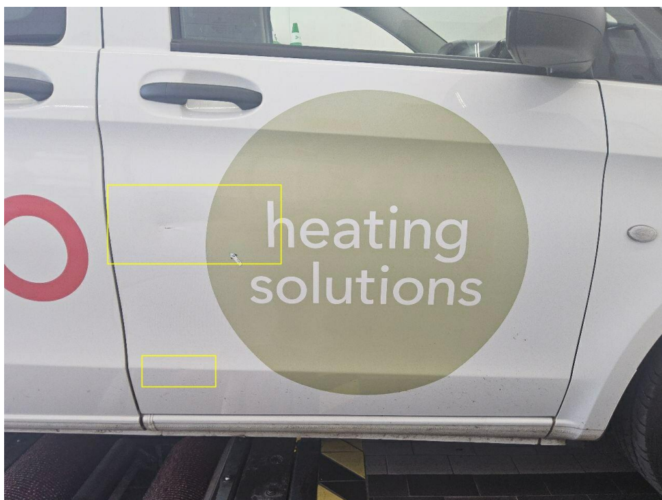
Bild 16 : Tür vorne rechts, eingedellt
