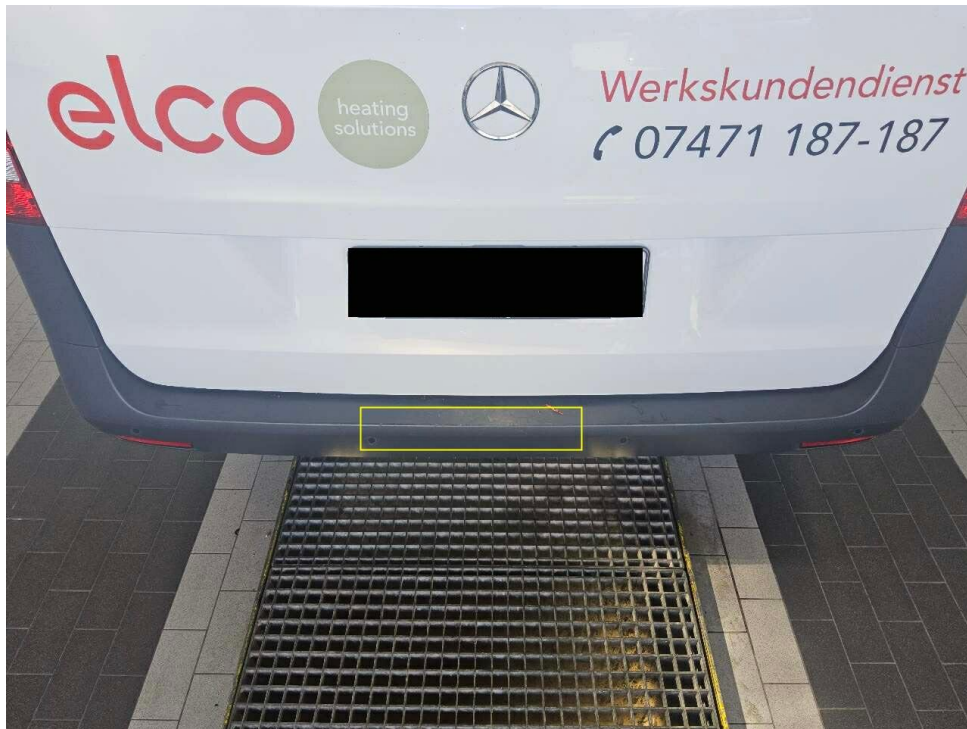
Bild 19 : Stoßfänger hinten, zerkratzt
