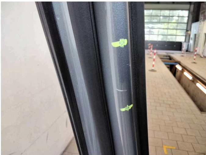
Damage 2: Door - front left side: Door (Innen) - Scratch(es) - Smart repair
