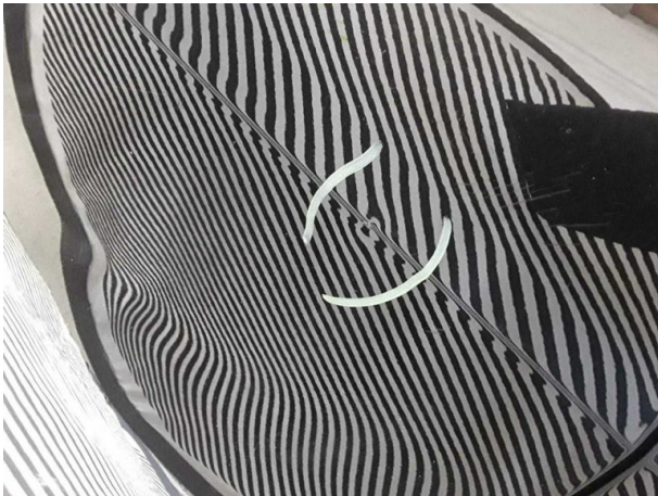
Beschädigung #9: Tür vorn rechts: Tür - Delle / Lackschaden - instandsetzen und lackieren
