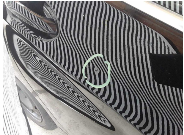
Beschädigung #6: Tür hinten rechts: Tür - Delle / Lackschaden... - instandsetzen und lackieren
