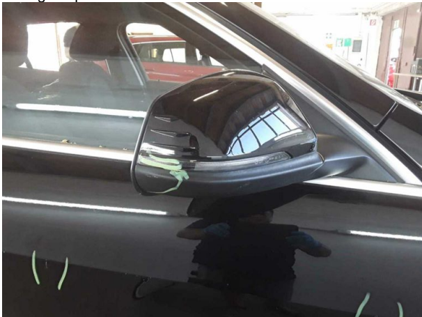
Beschädigung #3: Außenspiegel rechts: Spiegelgehäuse - verkratzt / verschürft - Wertminderung
