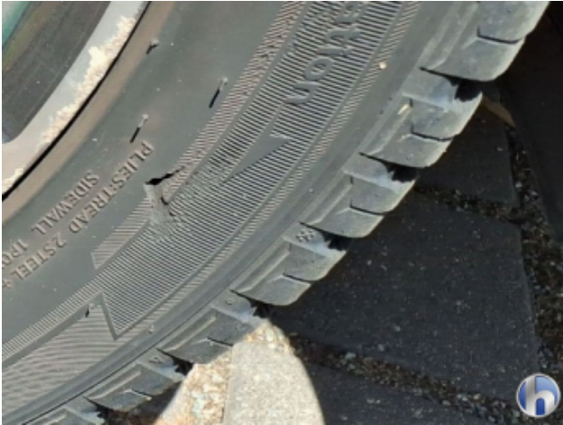
2. Reifen Vorne - Rechts Beschädigt - Erneuern
