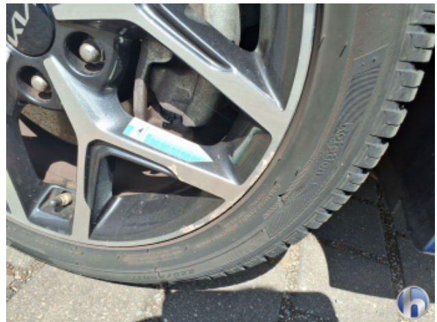
1. Felge Vorne - Rechts Kratzer - Smart Repair
