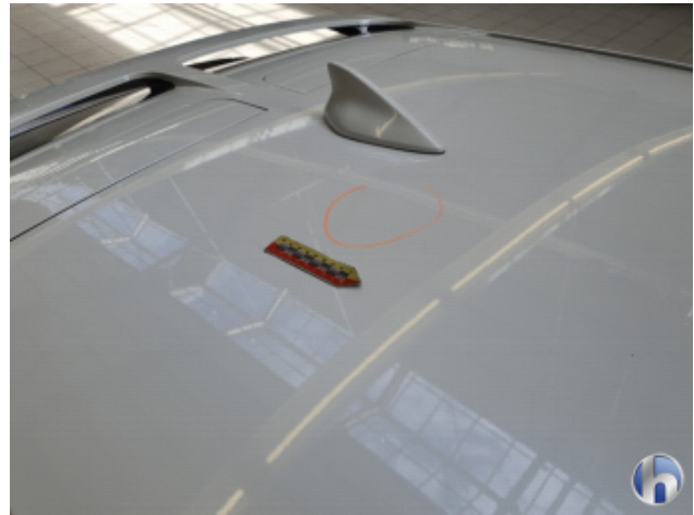
1. Dach 1 Delle - Sanft Instandsetzen
