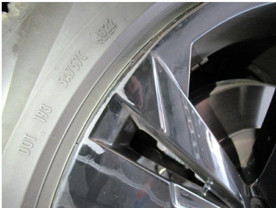
Bild 15 : Felge vorne links Lackierung, verschrammt, smart repair
