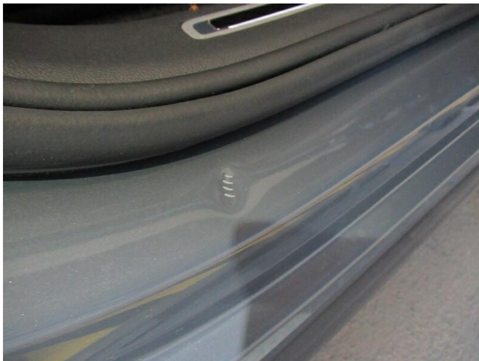
Bild 14 : Tür vorne rechts Einstieg, eingedellt, smart repair
