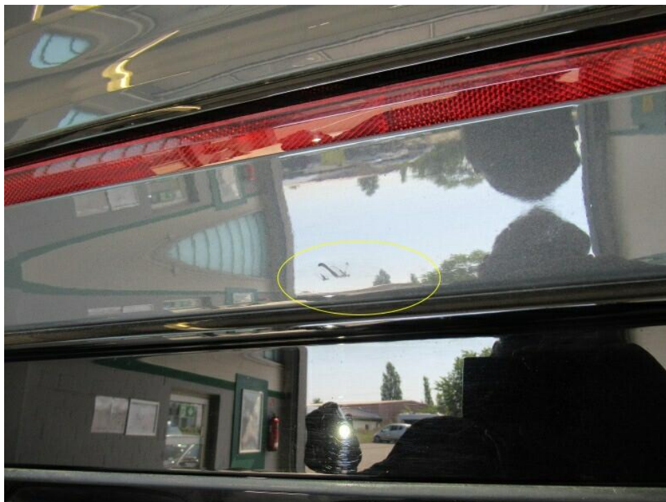
Bild 20 : Stoßfänger hinten Lackierung, zerkratzt, smart repair
