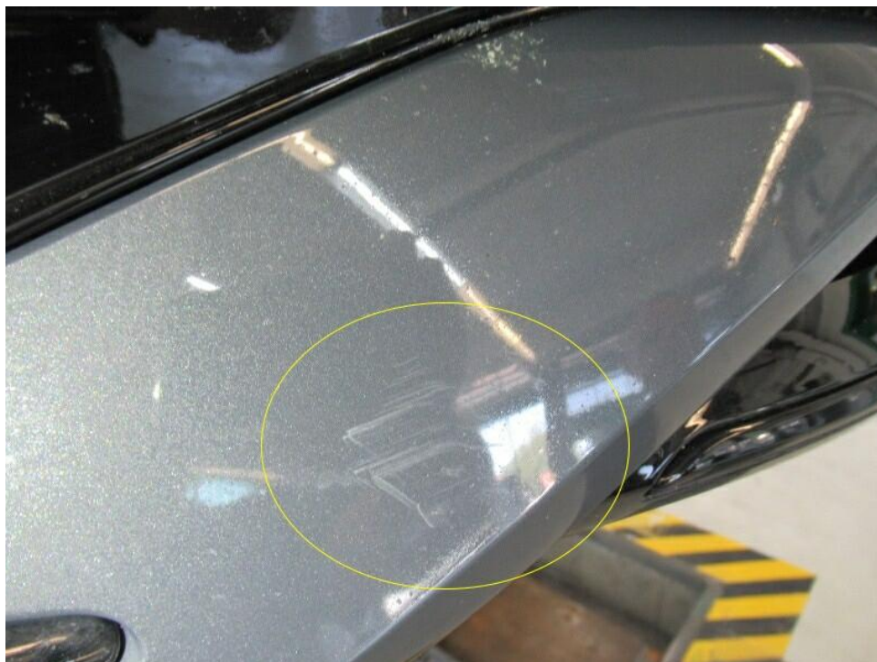
Bild 17 : Stoßfänger vorne Lackierung, verschrammt, smart repair
