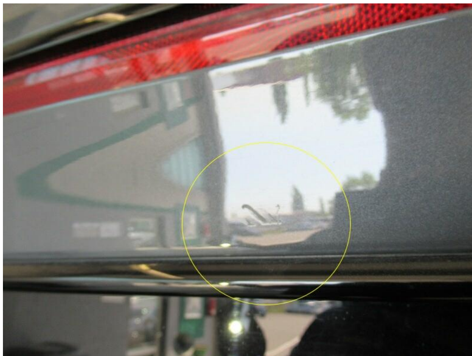
Bild 19 : Stoßfänger hinten Lackierung, zerkratzt, smart repair
