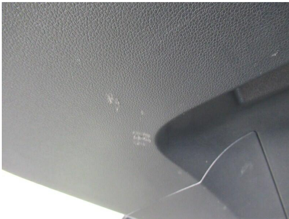
Bild 13 : Verkleidung Heckklappe, verschrammt, Gebrauchsspur
