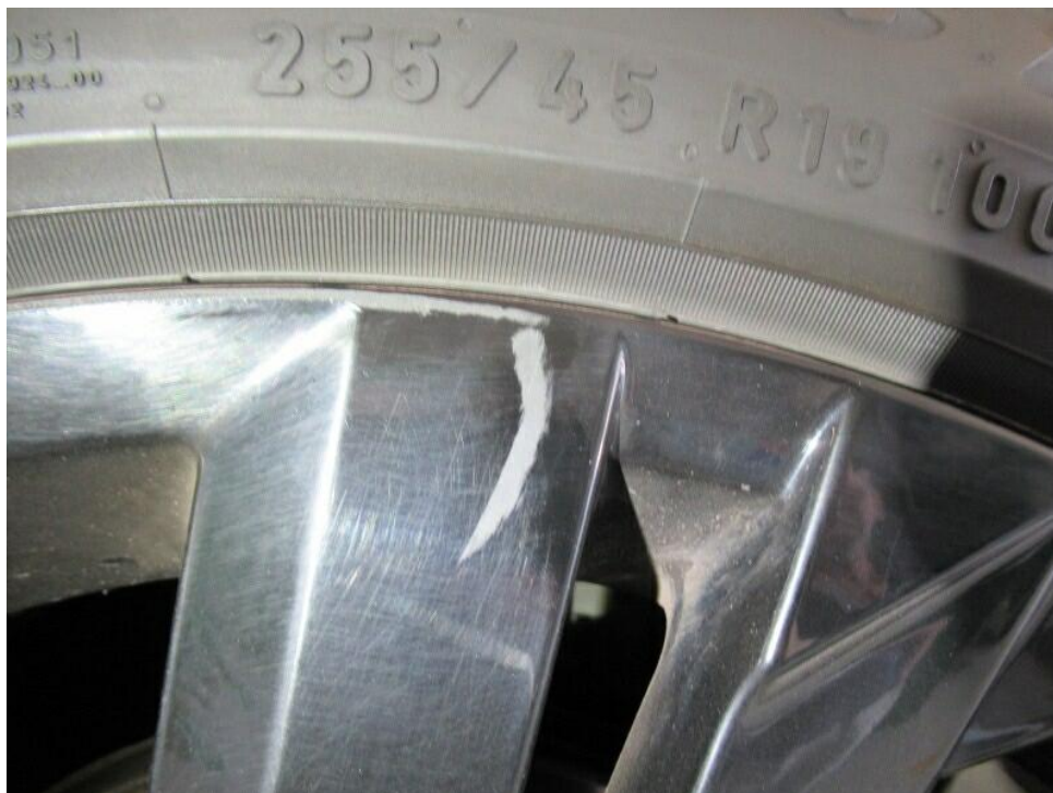
Bild 16 : Felge vorne rechts Lackierung, verschrammt, smart repair
