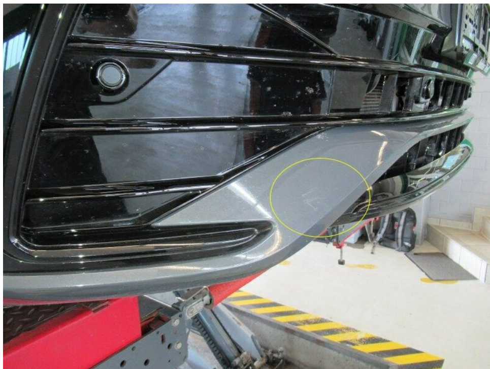
Bild 18 : Stoßfänger vorne Lackierung, verschrammt, smart repair
