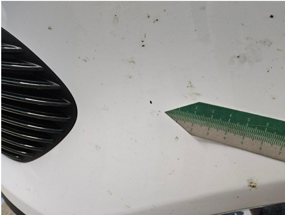
Bild 17 : Stoßfänger vorne Lackierung, Steinschlag, Gebrauchsspur
