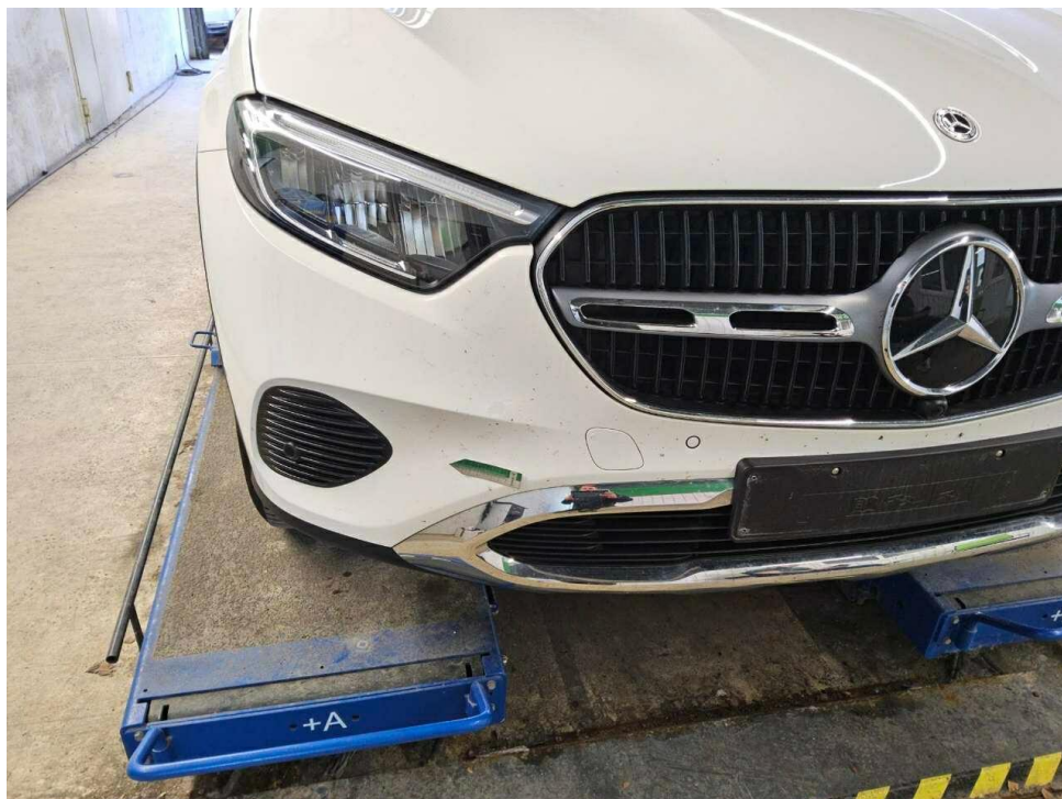
Bild 16 : Stoßfänger vorne Lackierung, Steinschlag, Gebrauchsspur
