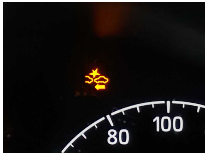
Damage 2: Instrument panel: Indicator light (Kollisionsassistent - Folgekosten möglich) - on - Perform diagnosis
