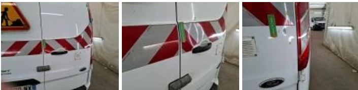
Coin pare-choc ARD, Déformé / Forcé, LI - Réparer et peindre (complet)
