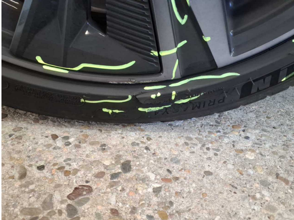
Beschädigung #3: Rad/Reifen: Reifen vorn rechts - beschädigt - erneuern
