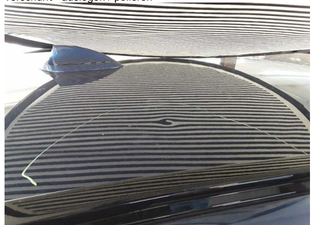
Beschädigung #3: Fahrzeugdach: Dach - Delle(n) - sanft instandsetzen
