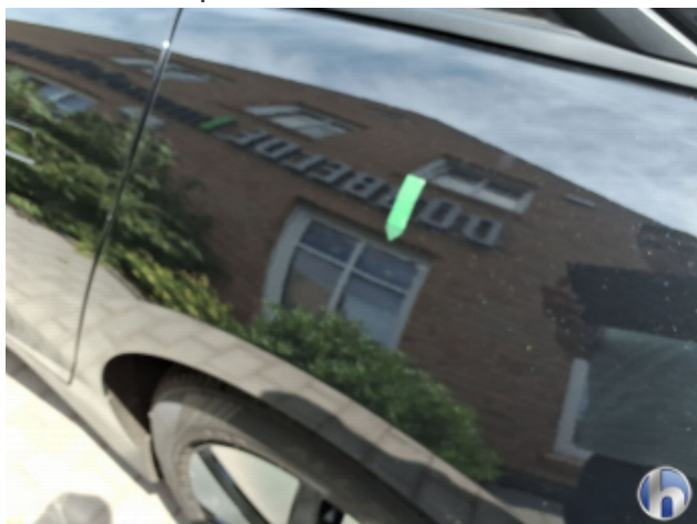
13. Seitenwand - Hinten - Links Kratzer - Smart Repair
