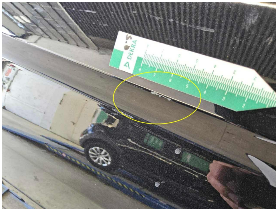
Bild 19 : Tür vorne rechts Lackierung, verschrammt, smart repair
