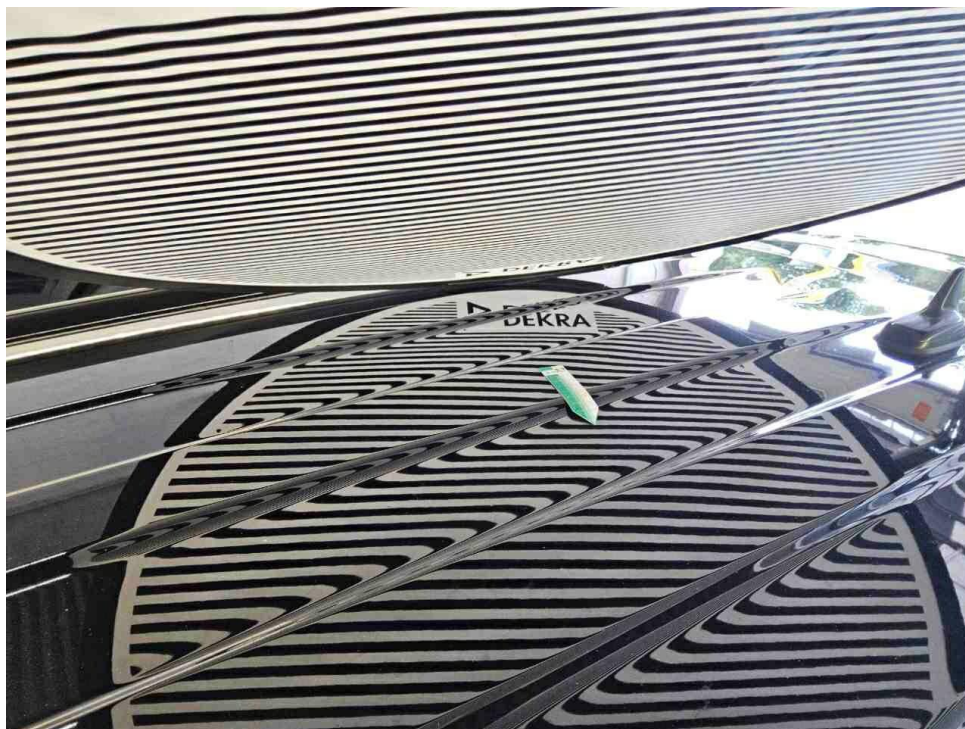
Bild 21 : Dach, eingedellt, Gebrauchsspur
