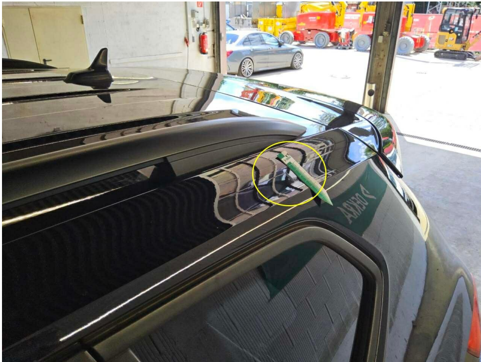
Bild 23 : Dachrahmen links Lackierung, Umweltschaden, lackieren mit Lackaufbau
