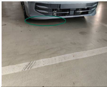
Stoßfänger Spoiler / Vorne / Kratzer
