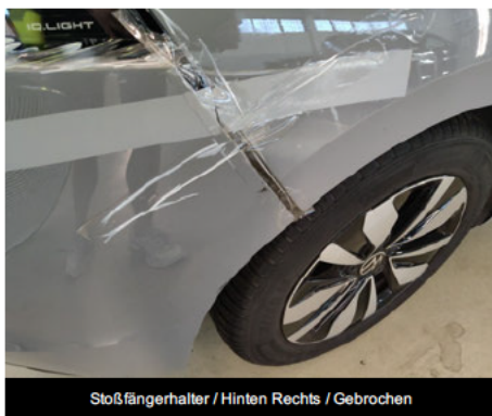
Stoßfänger / Hinten / Gebrochen
