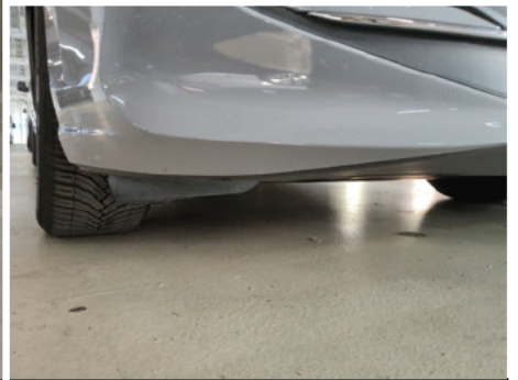
Stoßfänger Spoiler / Vorne / Kratzer
