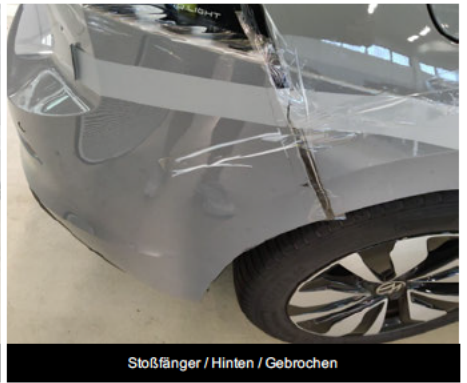
Stoßfänger / Hinten / Gebrochen
