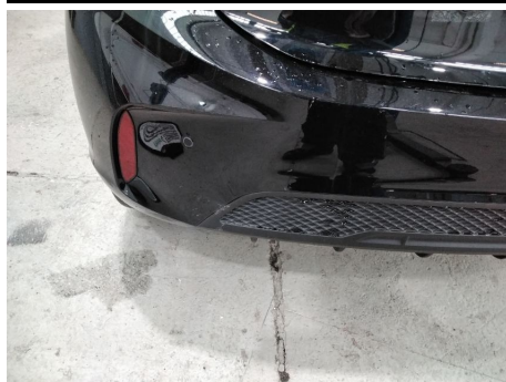
Stoßfängerleiste / Hinten / Kratzer
