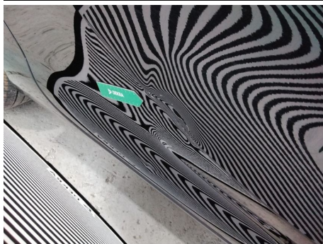
Tür / Hinten Rechts / Delle
