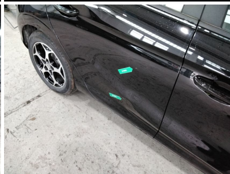
Tür / Hinten Rechts / Delle
