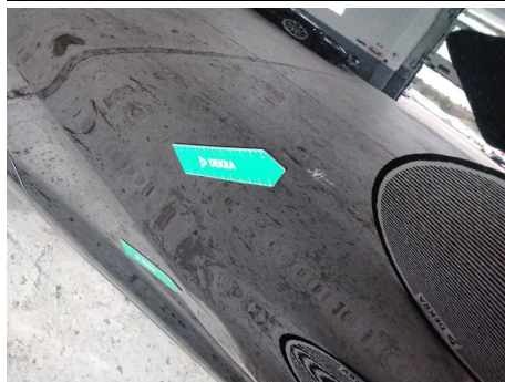
Tür / Hinten Rechts / Delle
