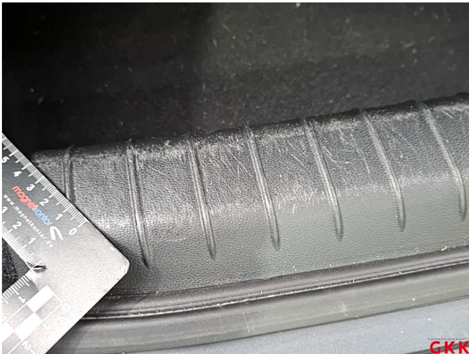
Bild 20. Ladekante, Abdeckung, verkratzt, ersetzen
