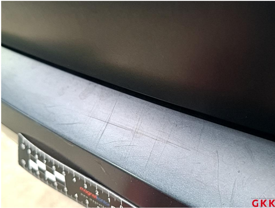
Bild 15. Stoßfänger hinten, Verkleidung oberhalb -unlackiert-, verkratzt, Smartrepair
