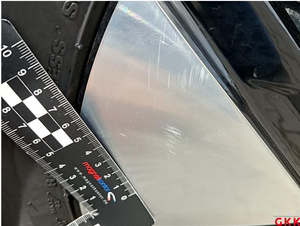
Bild 27. LM-Rad, vorne links, verkratzt, ersetzen
