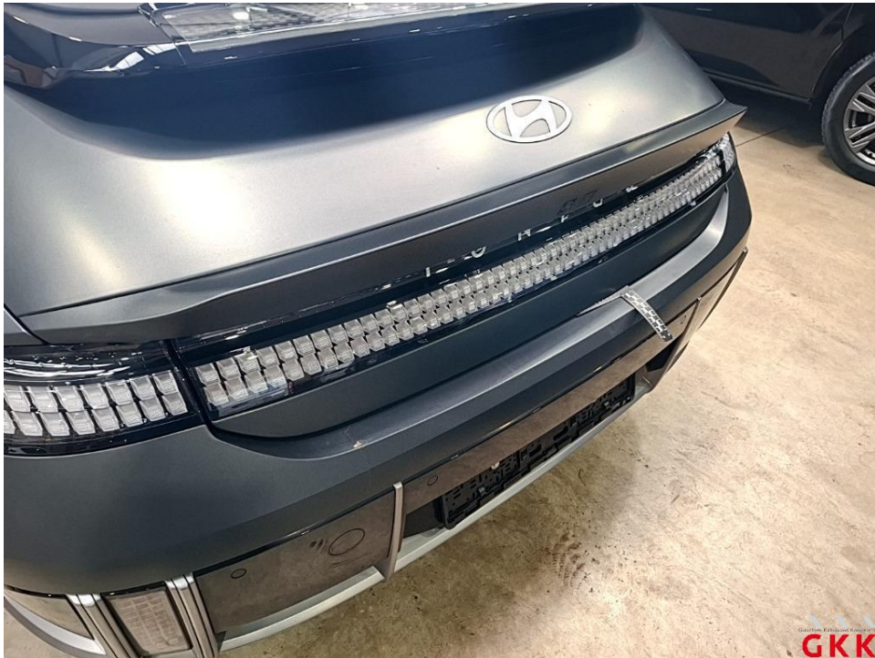
Bild 13. Stoßfänger hinten, Verkleidung oberhalb -unlackiert-, verkratzt, Smartrepair
