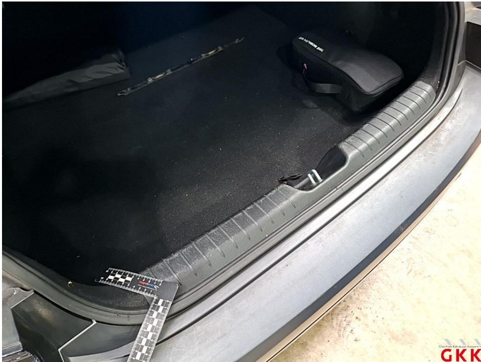
Bild 19. Ladekante, Abdeckung, verkratzt, ersetzen
