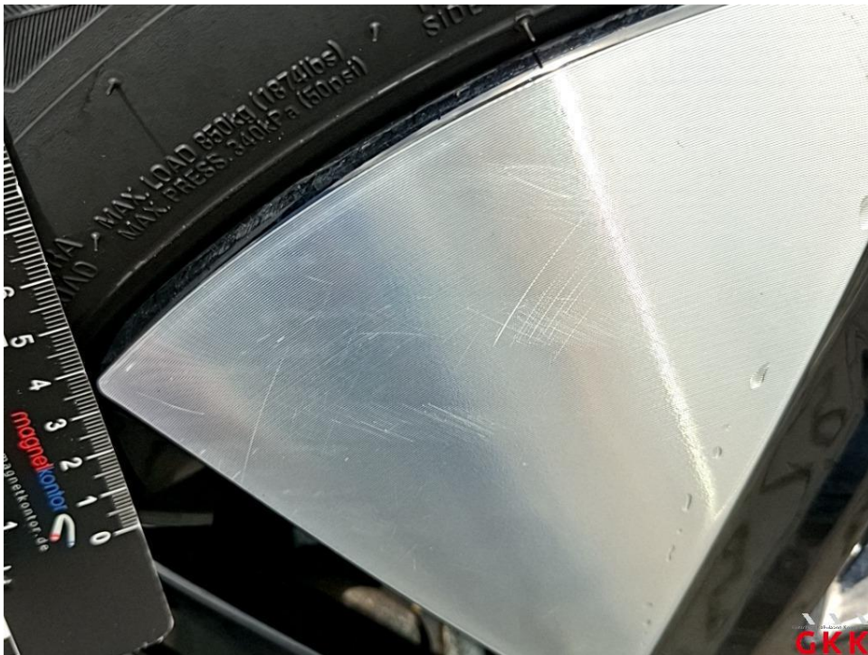
Bild 28. LM-Rad, vorne links, verkratzt, ersetzen
