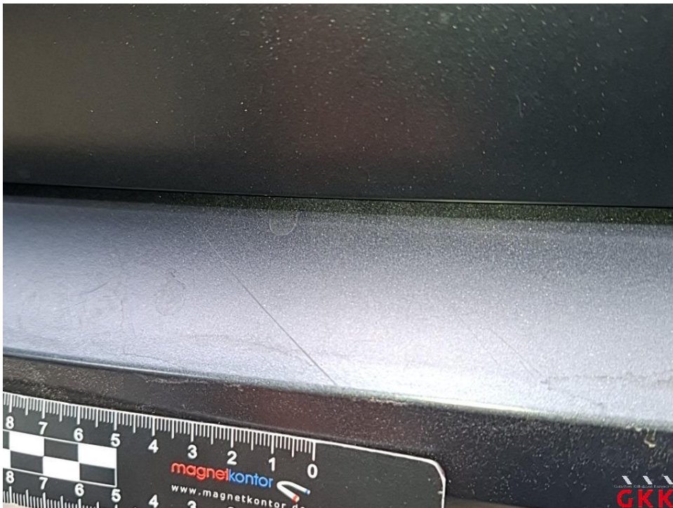
Bild 14. Stoßfänger hinten, Verkleidung oberhalb -unlackiert-, verkratzt, Smartrepair
