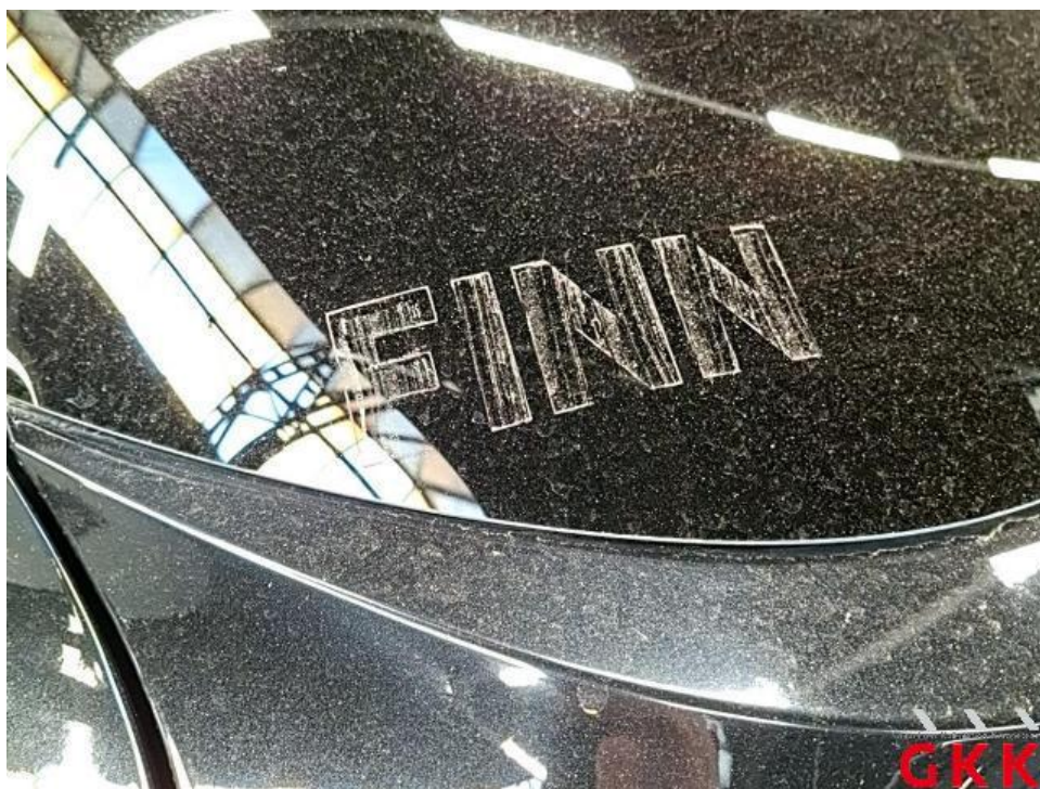
Bild 24 Folierung, Scheibe, Klebreste, entfernen
