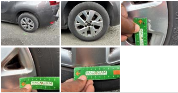
Alloy rim RR, Scratch(es), Repair/replace (lump sum)
