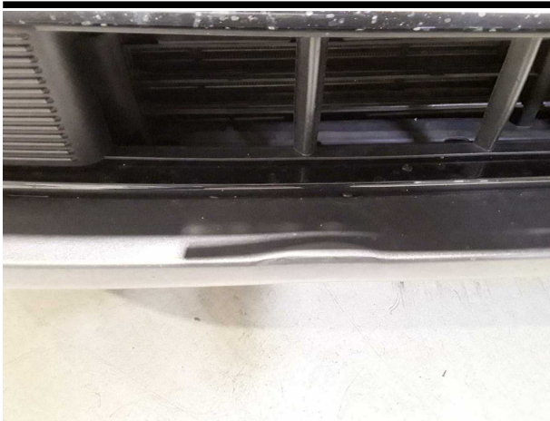
Beschädigung #4: Stossfänger vorn: Stossfänger vorn - verformt - erneuern
