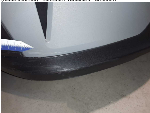
Beschädigung #4: Stossfänger vorn: Stossfänger vorn - verformt - erneuern
