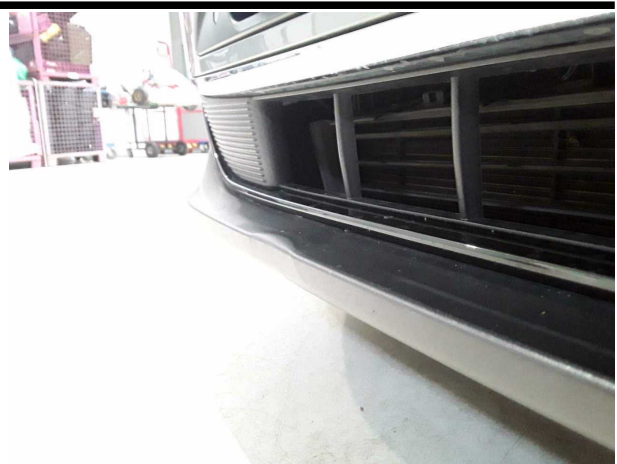
Beschädigung #4: Stossfänger vorn: Stossfänger vorn - verformt - erneuern
