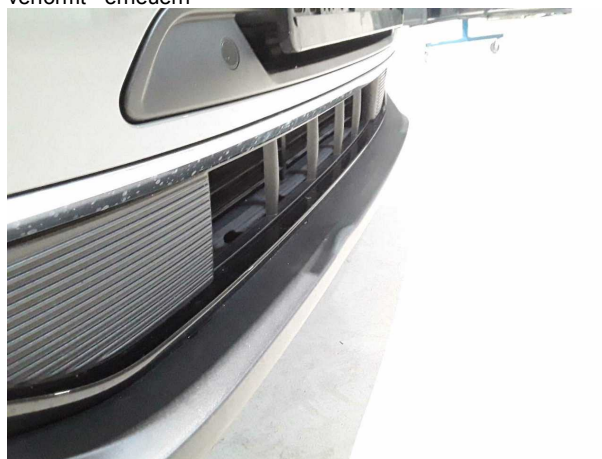
Beschädigung #4: Stossfänger vorn: Stossfänger vorn - verformt - erneuern
